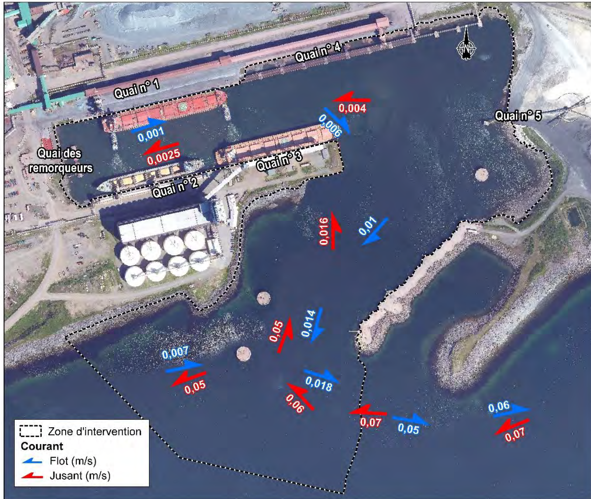
Figure 3-3. Synthèse des vitesses et directions des courants moyens en condition de marée moyenne
