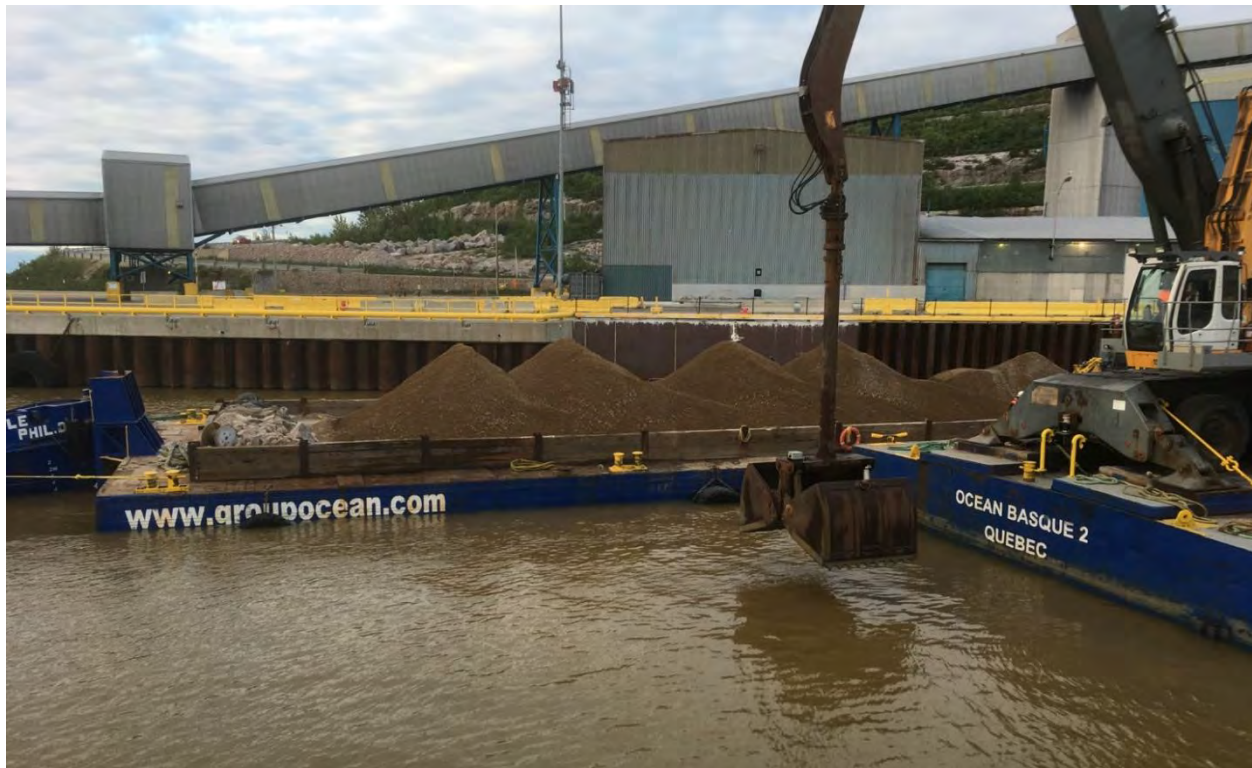
Photo 4-1. Exemple de barge à fond plat permettant l'égouttement des sédiments
