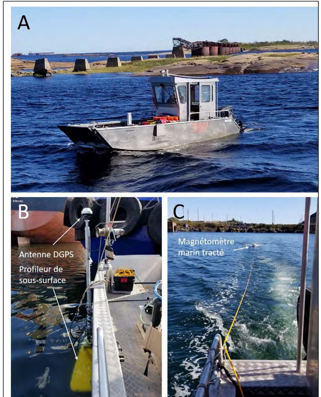
Figure 2.1 A) Plate-forme de travail, le Stanley. B) Profileur de sous-surface et antenne DGPS installés sur un pôle du côté bâbord du Stanley. C) Magnétomètre marin tracté 24 m derrière le Stanley.
