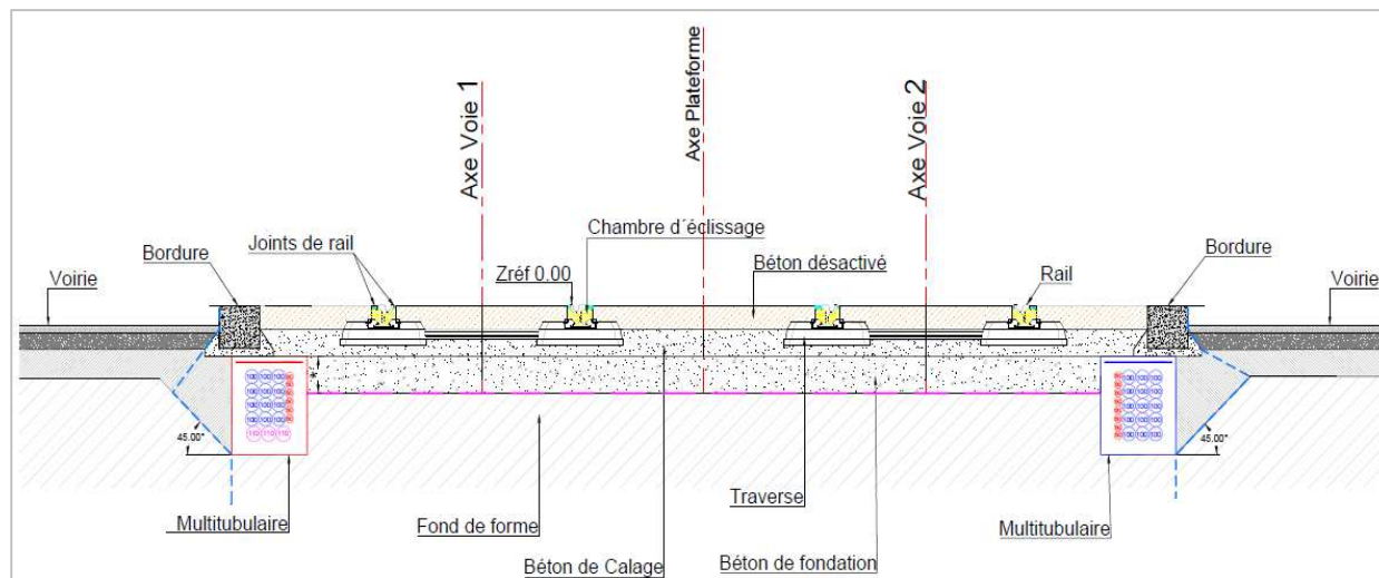
Figure 8 - Coupe type de plateforme classique de tramway
