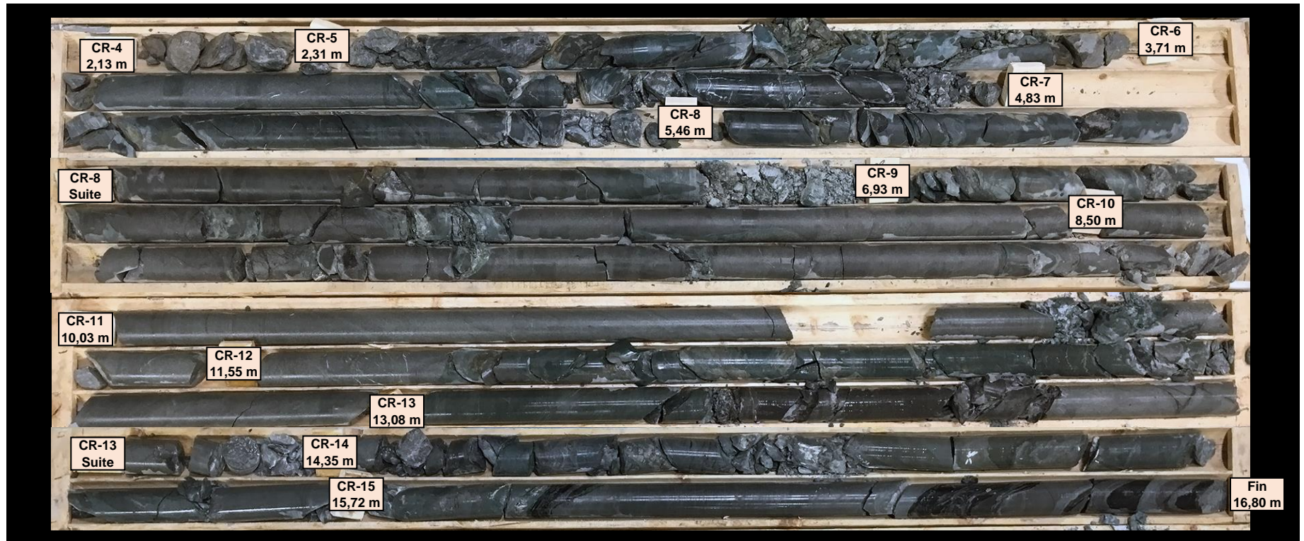
Photographie # 58 : Carottes de roc du forage TW10-F-31 état humide (CR-4 à CR-15).
