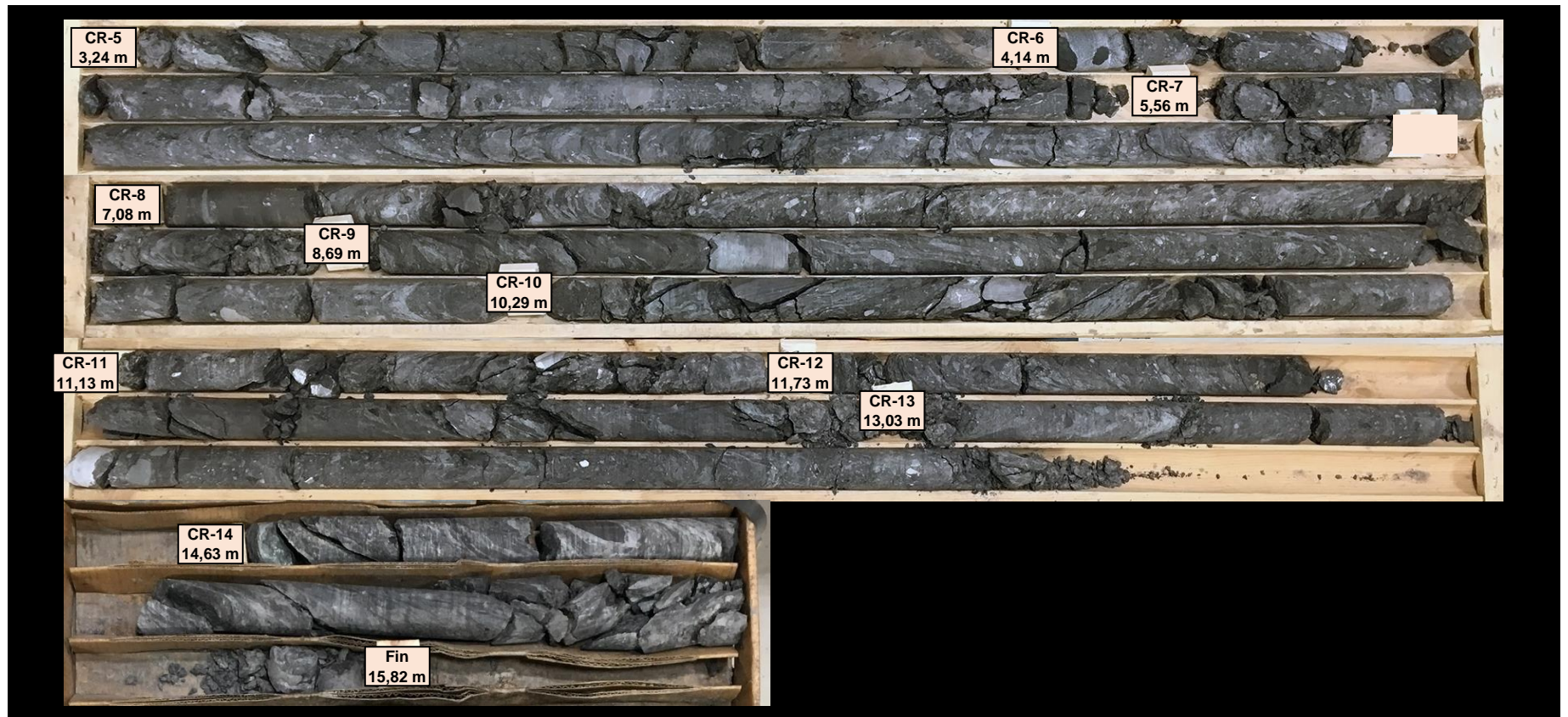
Photographie # 73 : Carottes de roc du forage TW10-F-40 état sec (CR-5 à CR-14).
