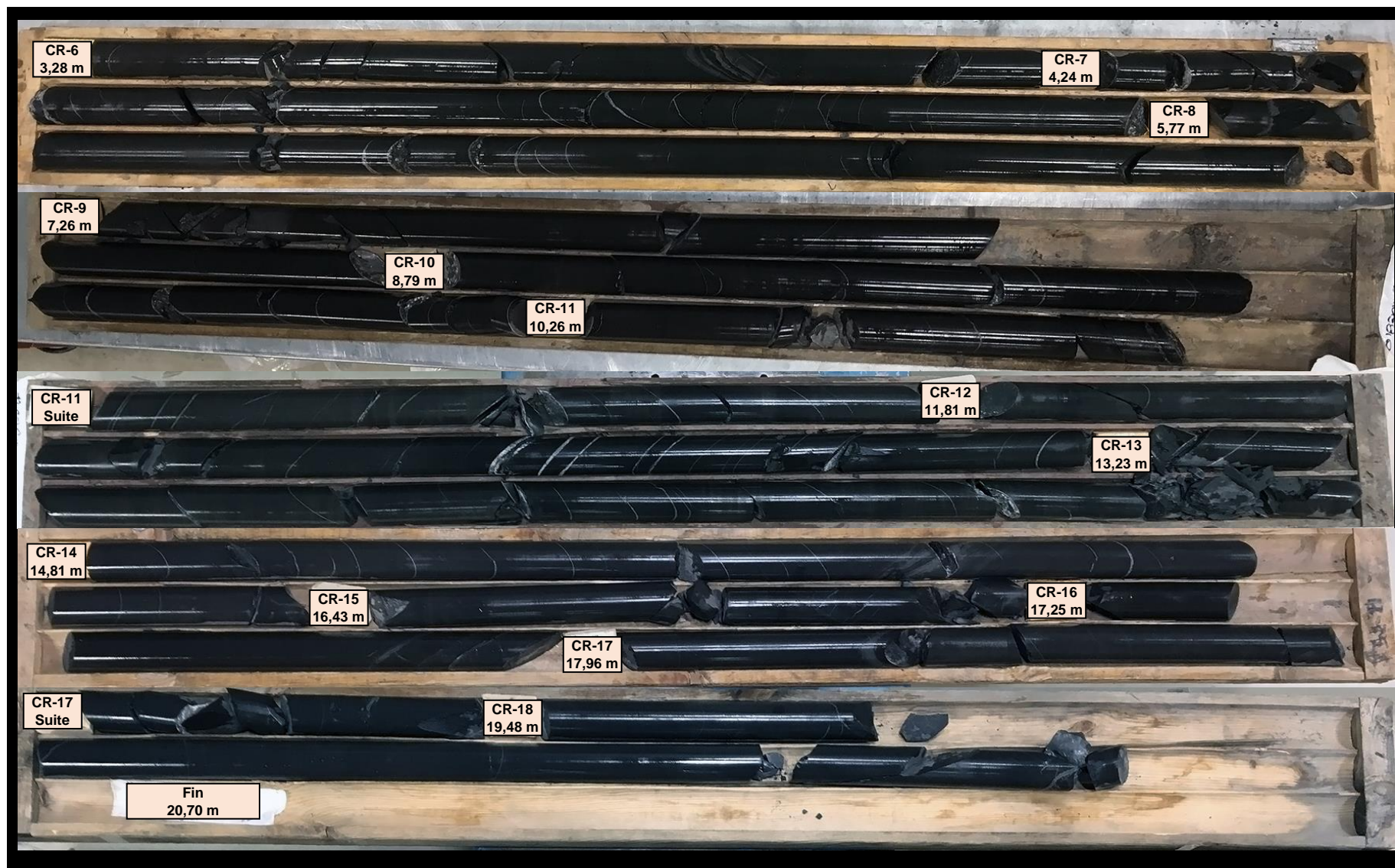
Photographie # 44 : Carottes de roc du forage TW10-F-22 état humide (CR-6 à CR-18).
