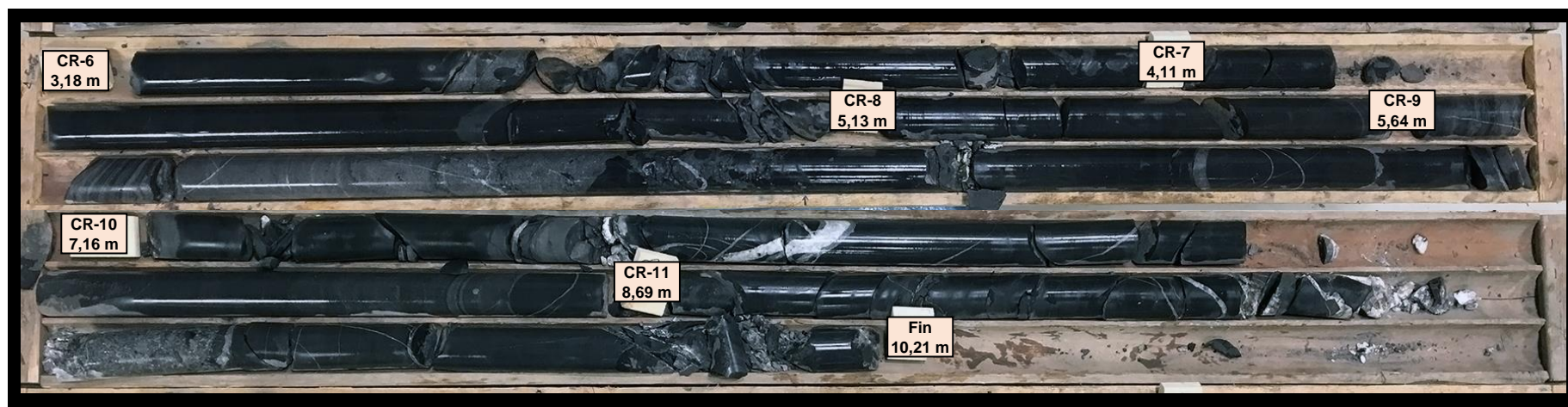
Photographie # 64 : Carottes de roc du forage TW10-F-35 état humide (CR-6 à CR-11).
