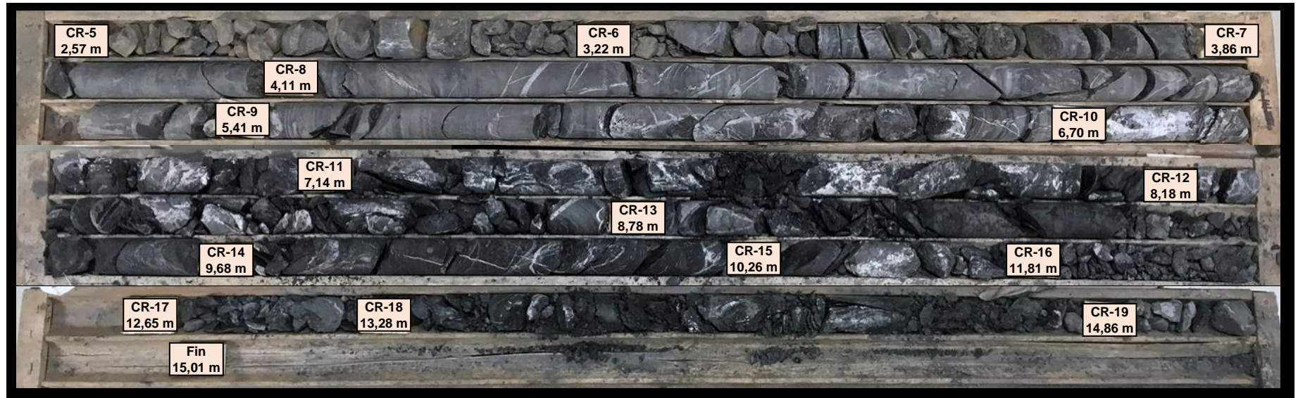
Photographie # 15 : Carottes de roc du forage TW10-F-08 état sec (CR-5 à CR-19).
