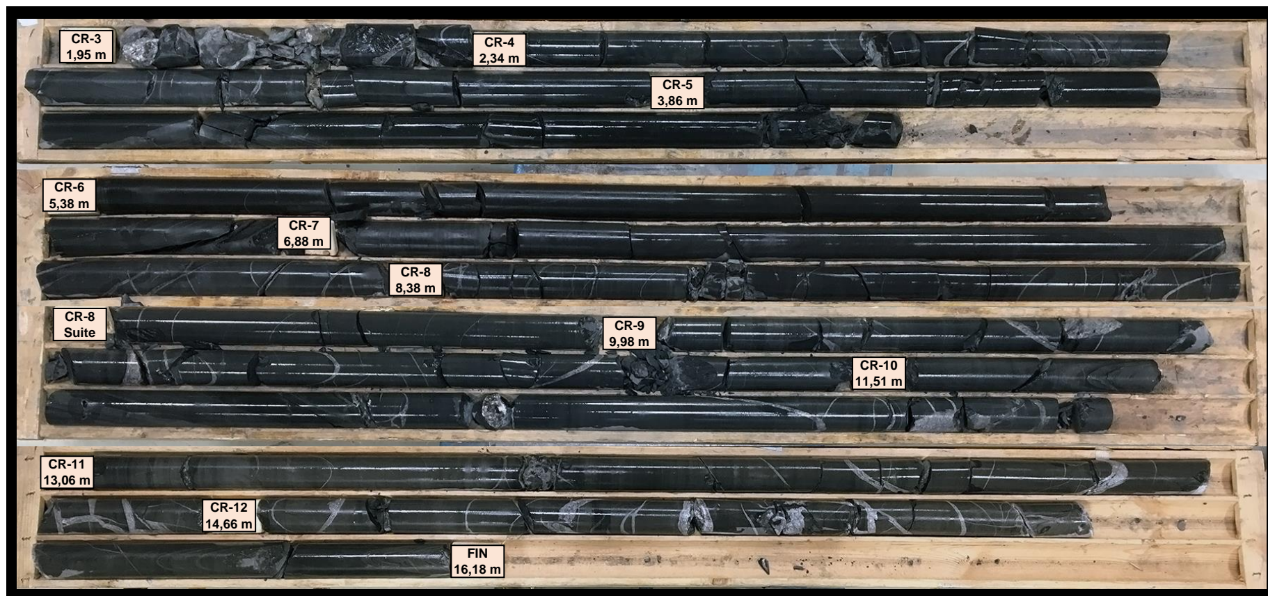
Photographie # 24 : Carottes de roc du forage TW10-F-12 état humide (CR-3 à CR-12).
