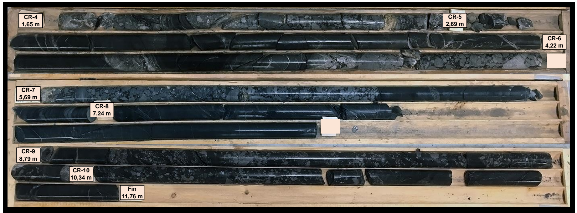
Photographie # 92 : Carottes de roc du forage TW10-F-49 état humide (CR-4 à CR-10).
