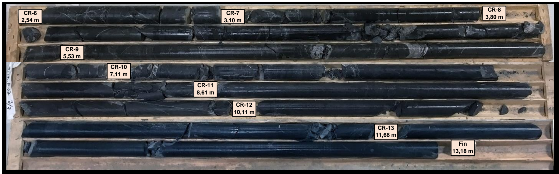
Photographie # 4 : Carottes de roc du forage TW10-F-02 état mouillé (CR-6 à CR-13)
