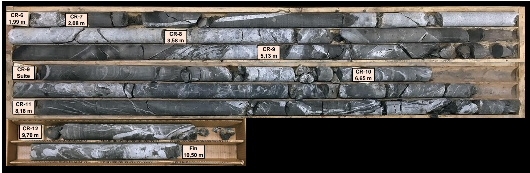
Photographie # 85 : Carottes de roc du forage TW10-F-46 état sec (CR-6 à CR-12).
