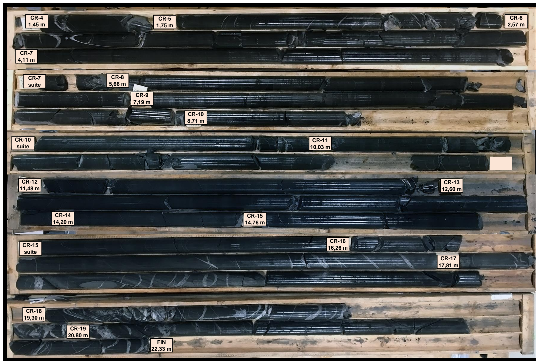
Photographie # 26 : Carottes de roc du forage TW10-F-13 état humide (CR-4 à CR-19).
