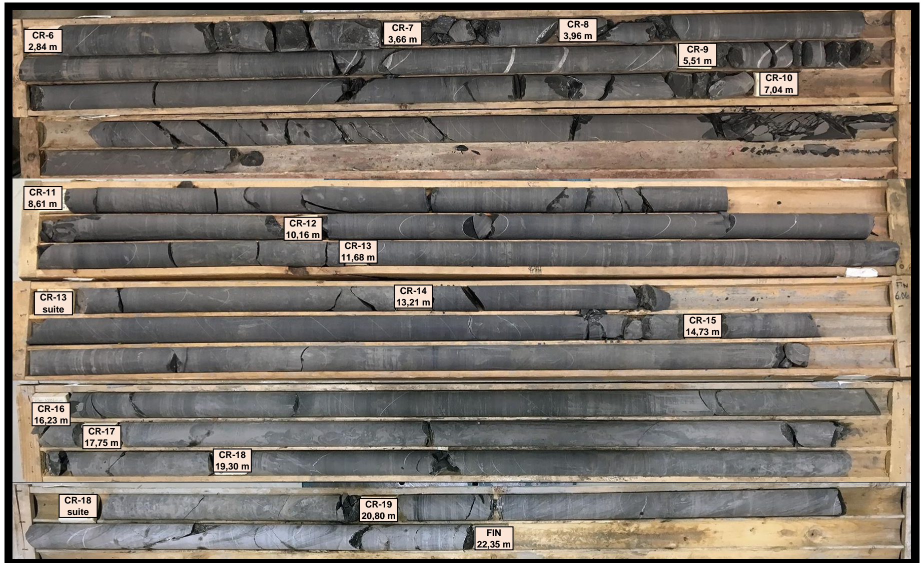
Photographie # 29 : Carottes de roc du forage TW10-F-15 état sec (CR-6 à CR-19).
