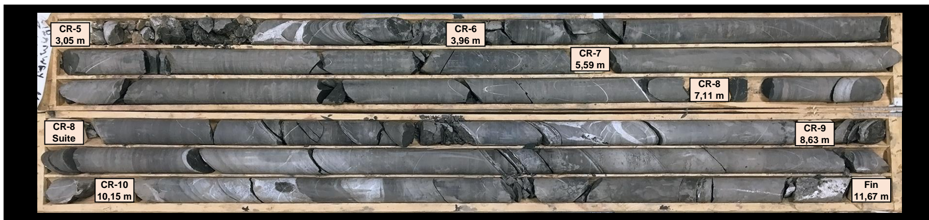
Photographie # 79 : Carottes de roc du forage TW10-F-43B état sec (CR-5 à CR-10).
