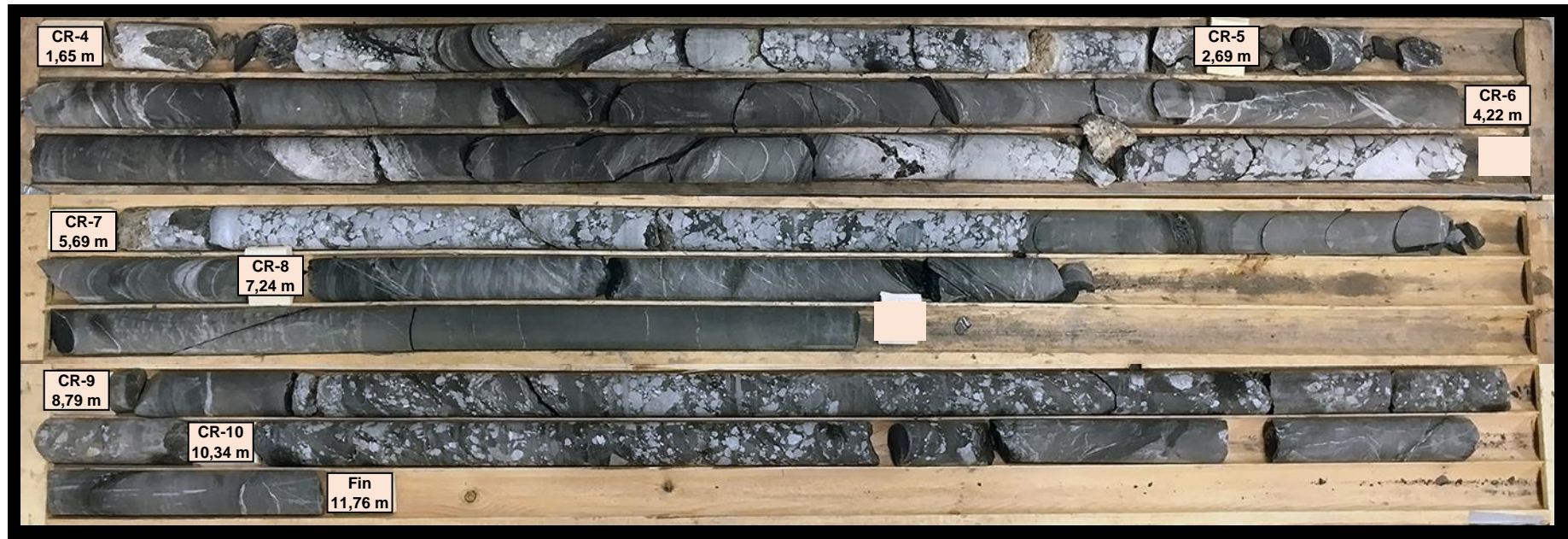
Photographie # 91 : Carottes de roc du forage TW10-F-49 état sec (CR-4 à CR-10).
