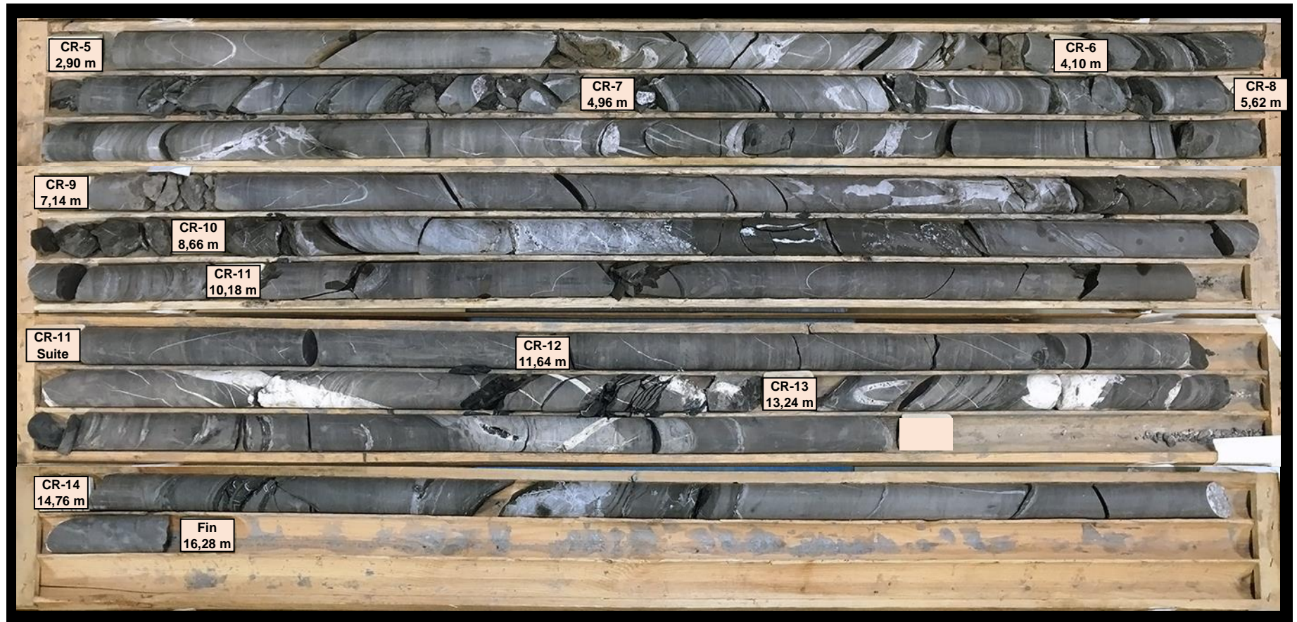
Photographie # 61 : Carottes de roc du forage TW10-F-33 état sec (CR-5 à CR-14).
