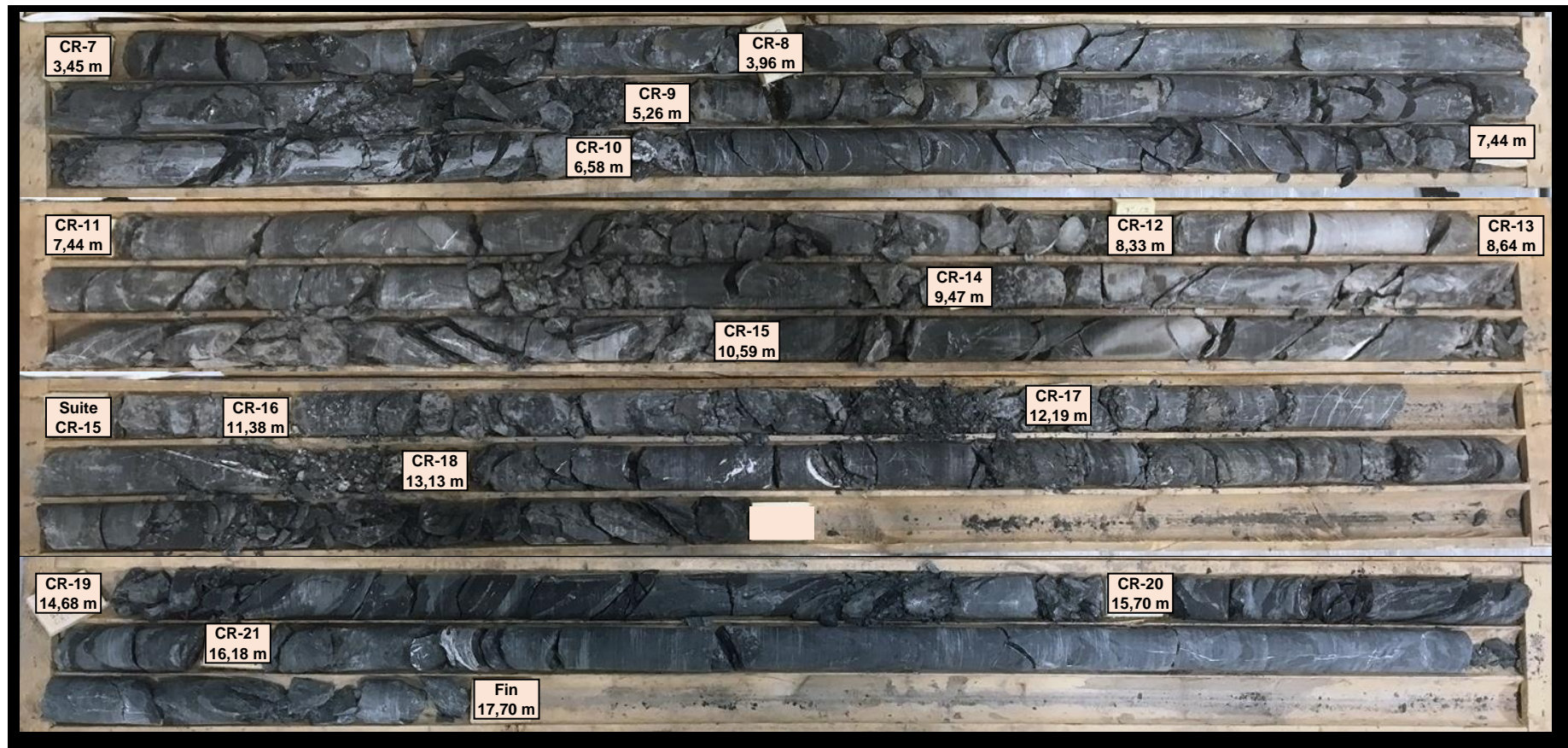
Photographie # 7 : Carottes de roc du forage TW10-F-04 état sec (CR-7 à CR-21).
