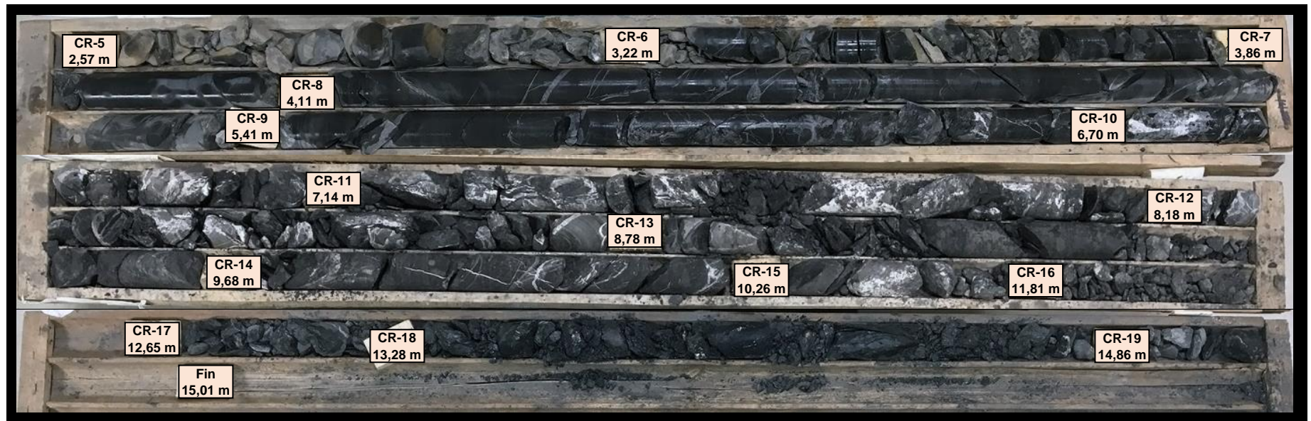
Photographie # 16 : Carottes de roc du forage TW10-F-08 état mouillé (CR-5 à CR-19).
