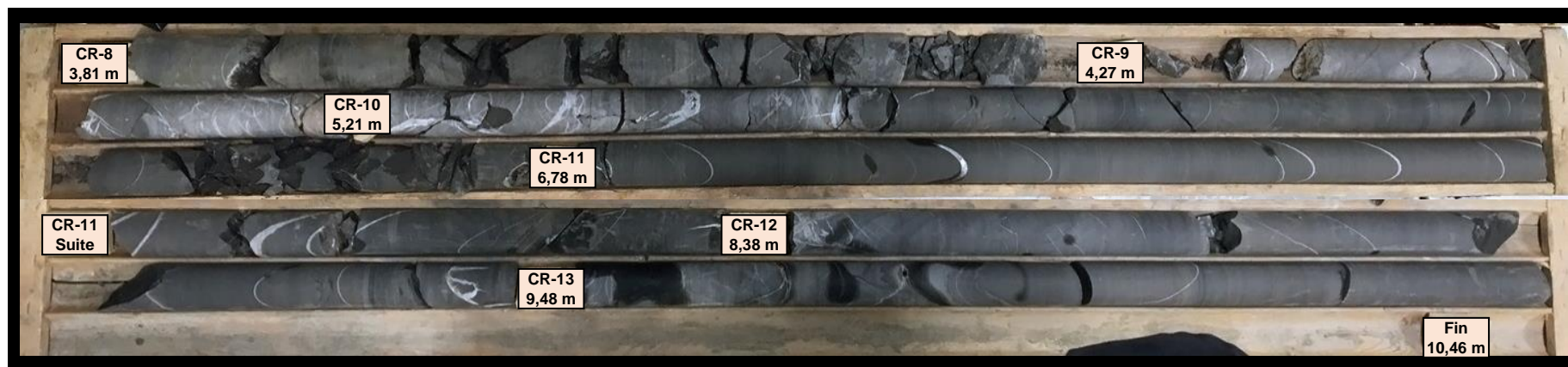
Photographie # 37 : Carottes de roc du forage TW10-F-19 état sec (CR-8 à CR-13).
