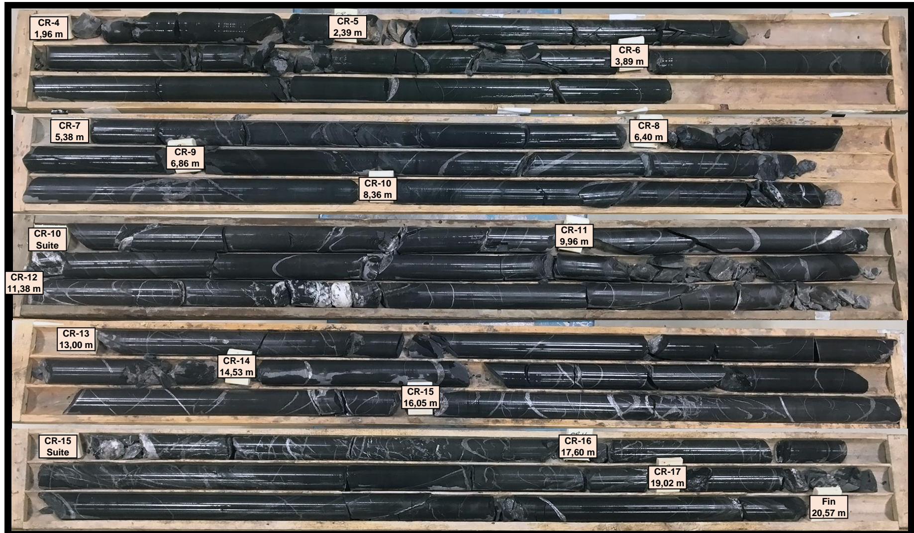
Photographie # 36 : Carottes de roc du forage TW10-F-18 état humide (CR-4 à CR-17).
