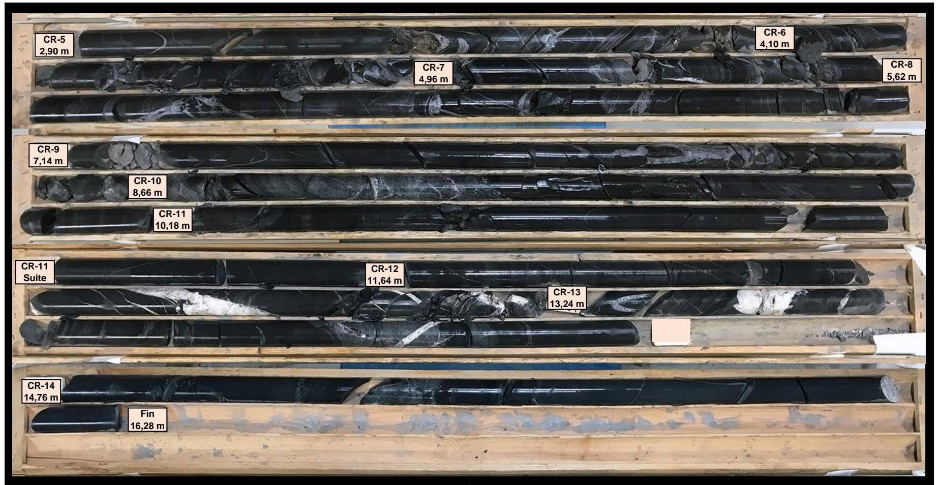
Photographie # 62 : Carottes de roc du forage TW10-F-33 état humide (CR-5 à CR-14).
