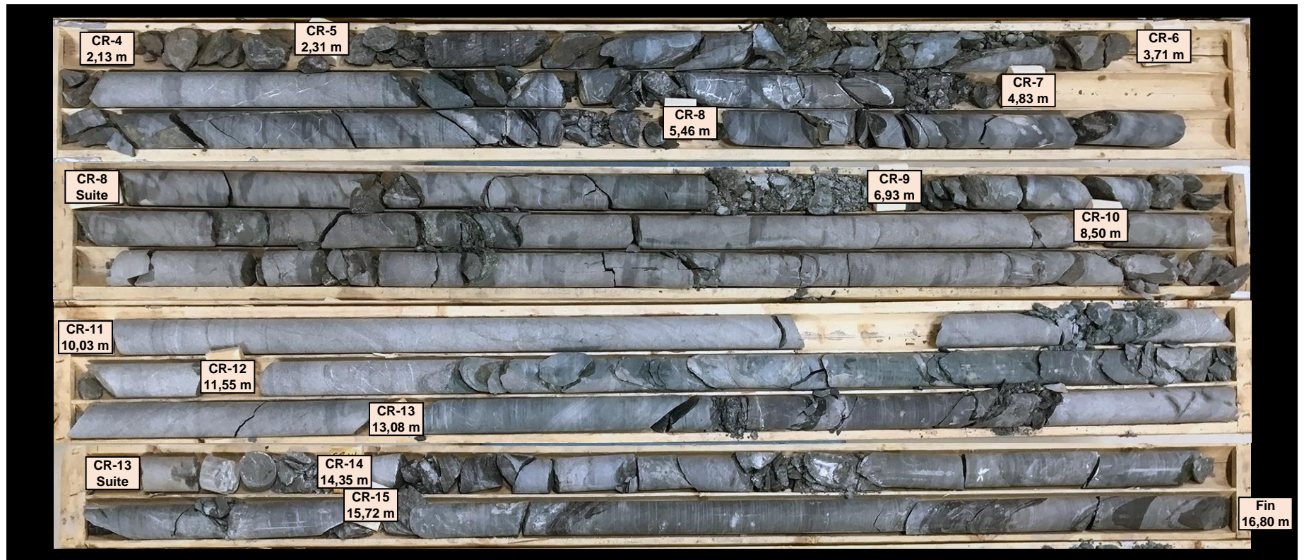
Photographie # 57 : Carottes de roc du forage TW10-F-31 état sec (CR-4 à CR-15).
