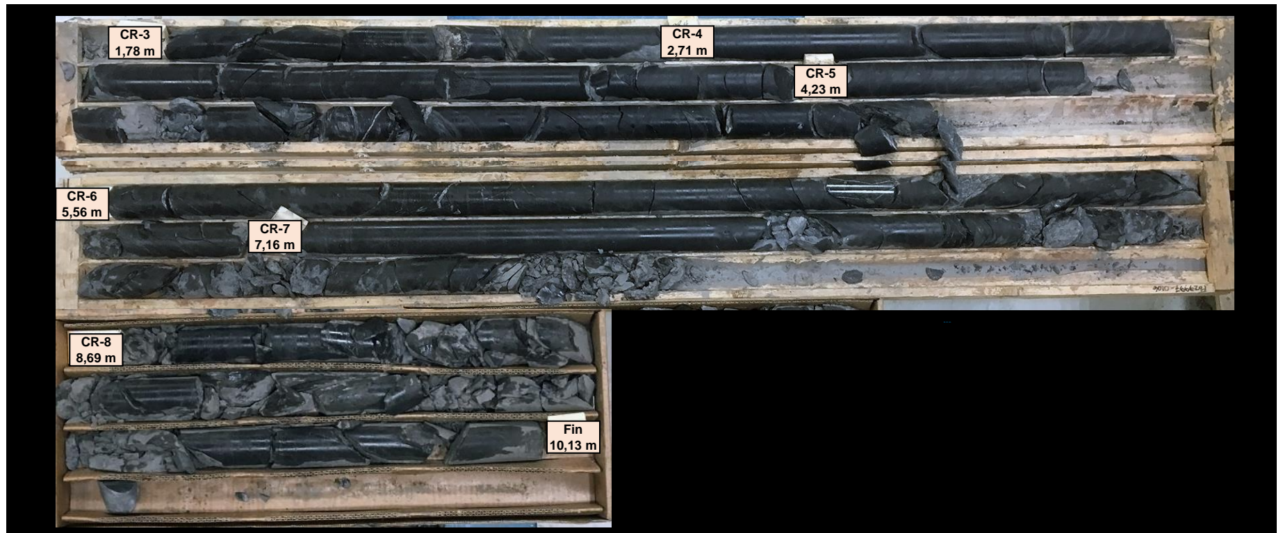
Photographie # 56 : Carottes de roc du forage TW10-F-30 état humide (CR-3 à CR-8).
