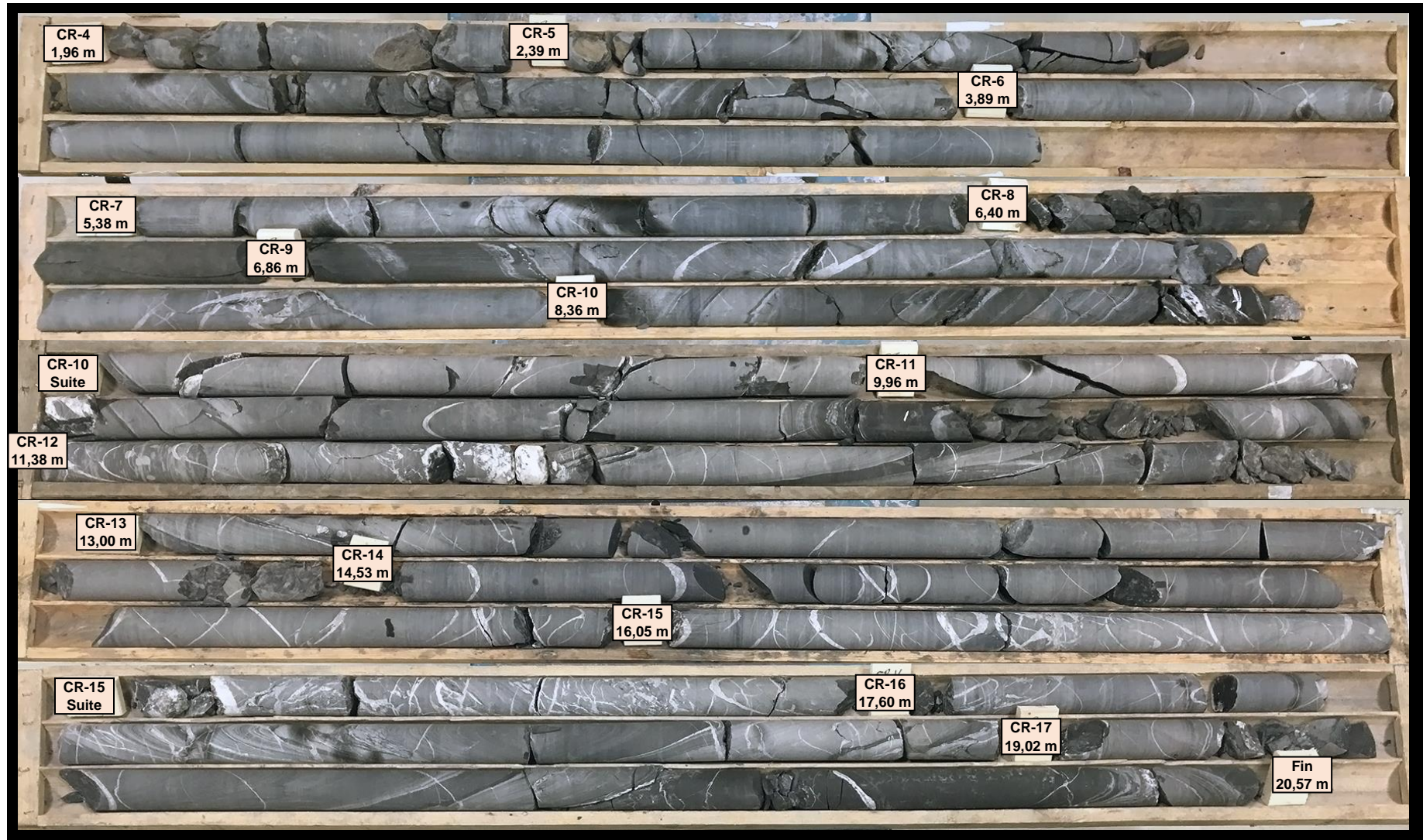
Photographie # 35 : Carottes de roc du forage TW10-F-18 état sec (CR-4 à CR-17).
