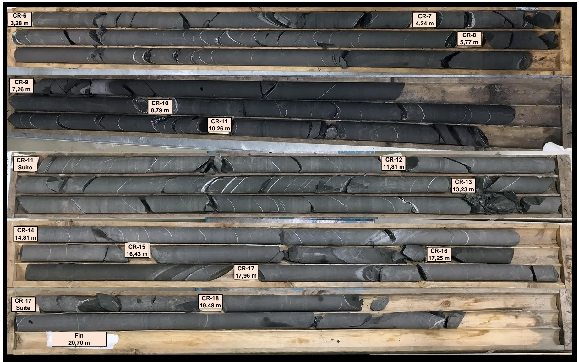
Photographie # 43 : Carottes de roc du forage TW10-F-22 état sec (CR-6 à CR-18).
