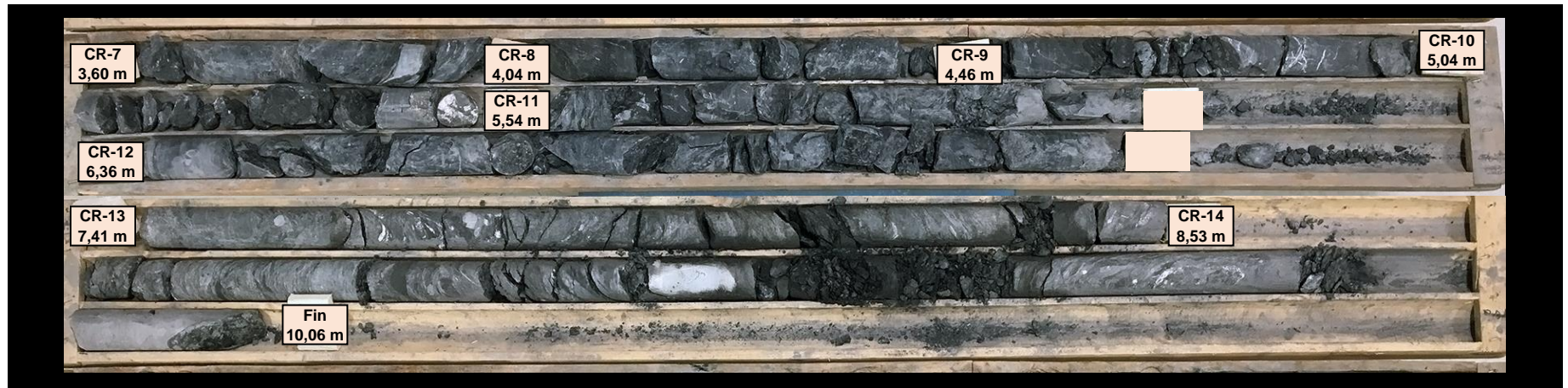
Photographie # 69 : Carottes de roc du forage TW10-F-38 état sec (CR-7 à CR-14).
