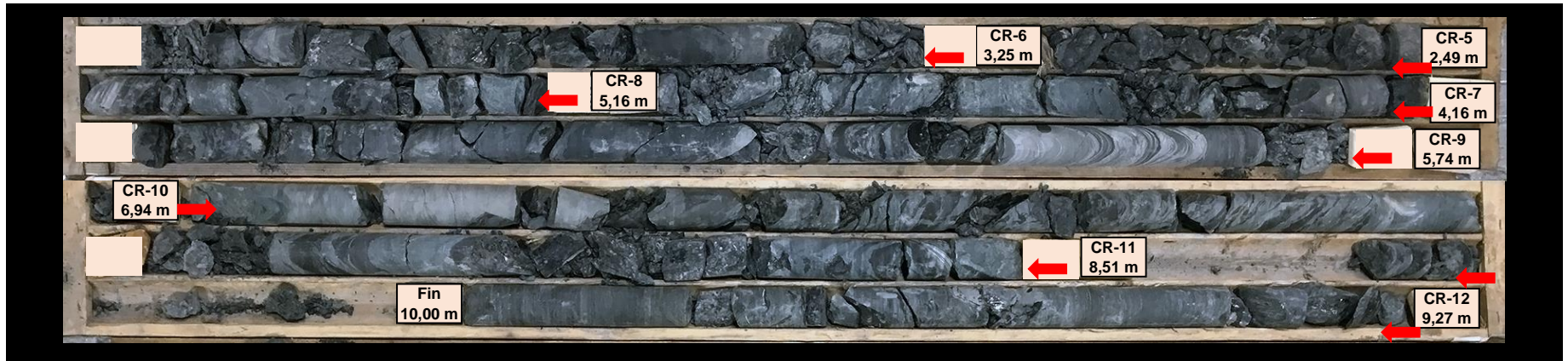
Photographie # 95 : Carottes de roc du forage TW10-F-51 état sec (CR-5 à CR-12).
