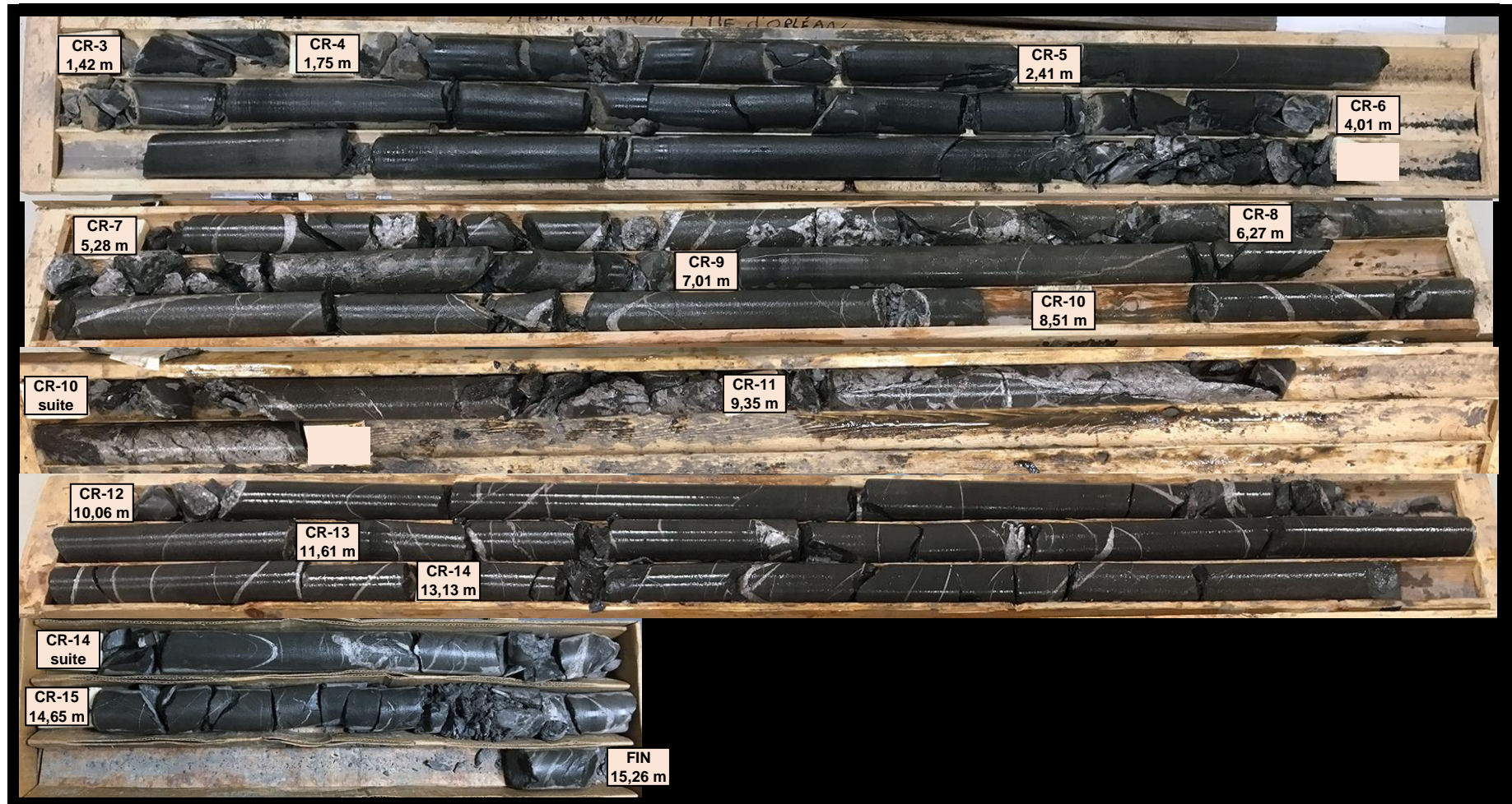
Photographie # 20 : Carottes de roc du forage TW10-F-10 état humide (CR-3 à CR-15).
