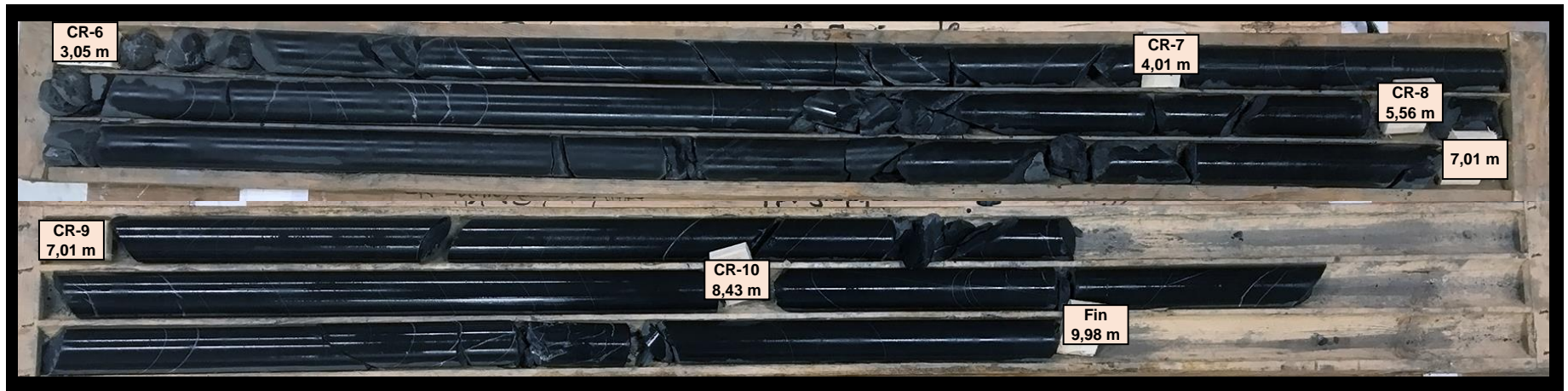
Photographie # 40 : Carottes de roc du forage TW10-F-20 état mouillé (CR-6 à CR-10).
