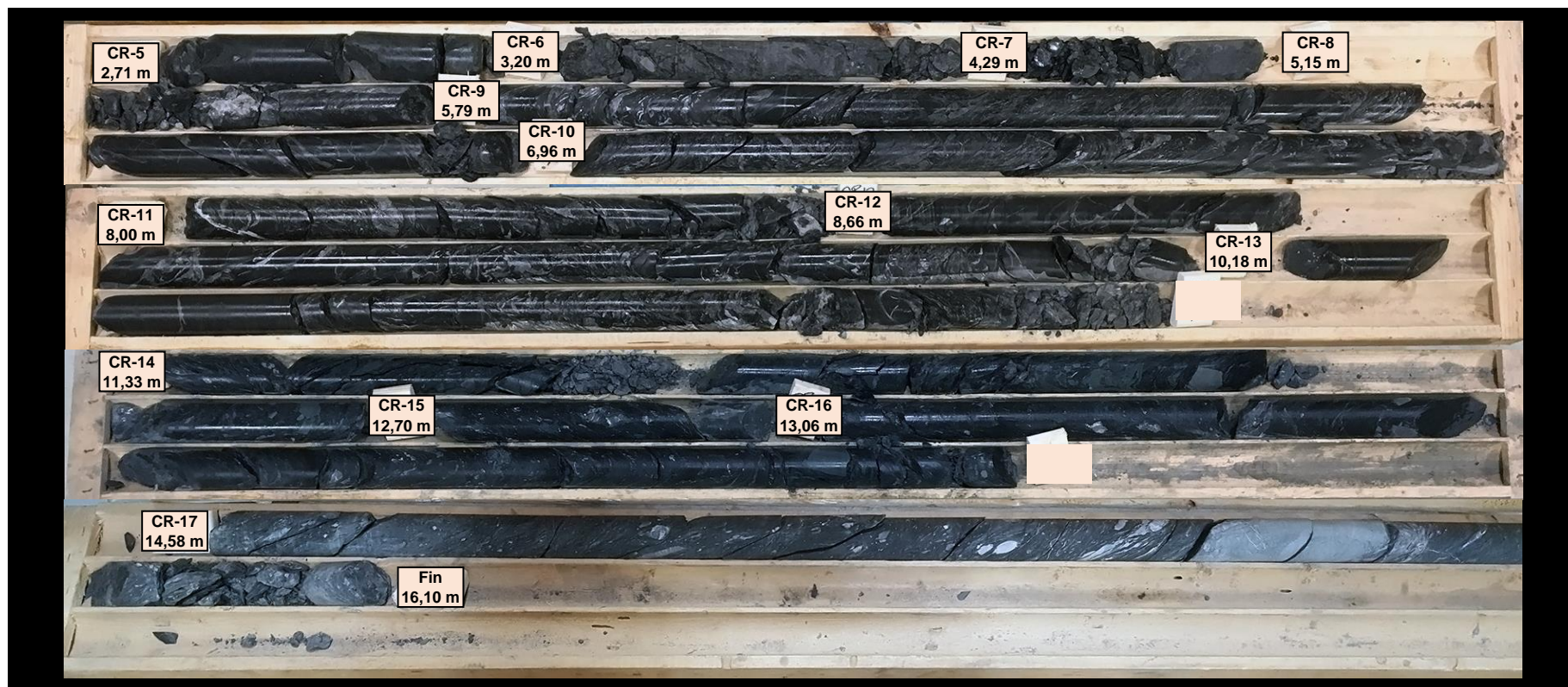
Photographie # 98 : Carottes de roc du forage TW10-F-52 état humide (CR-5 à CR-16) (CR-17 est à l'état sec).
