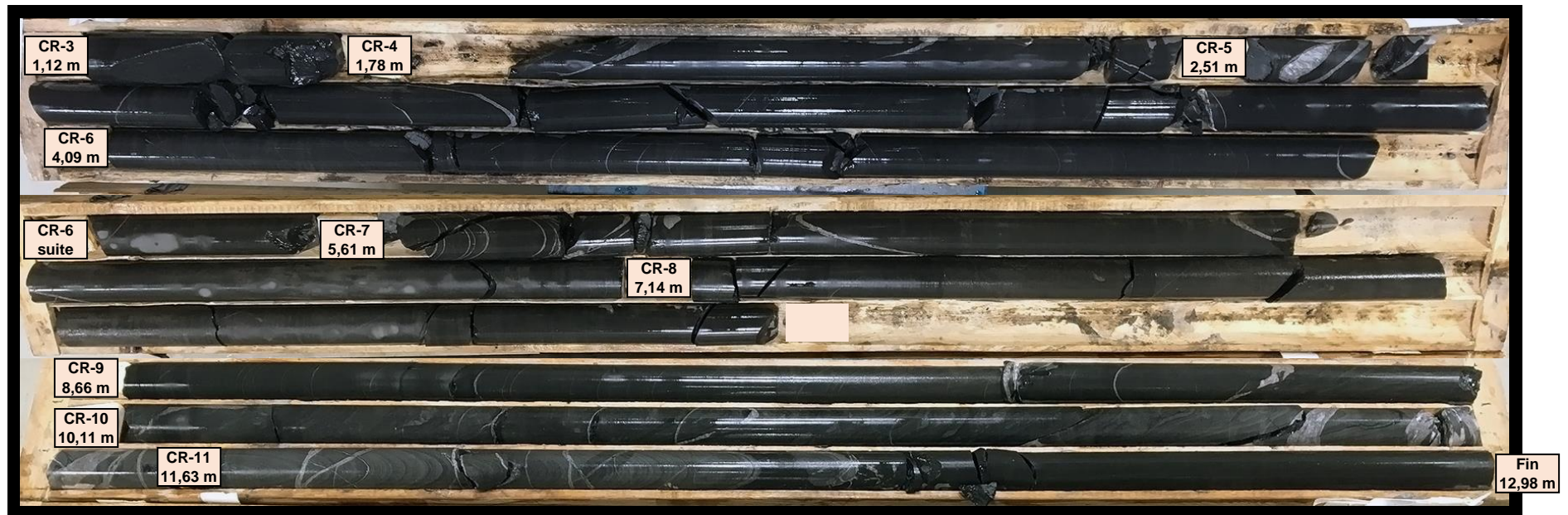
Photographie # 28 : Carottes de roc du forage TW10-F-14 état humide (CR-3 à CR-11).
