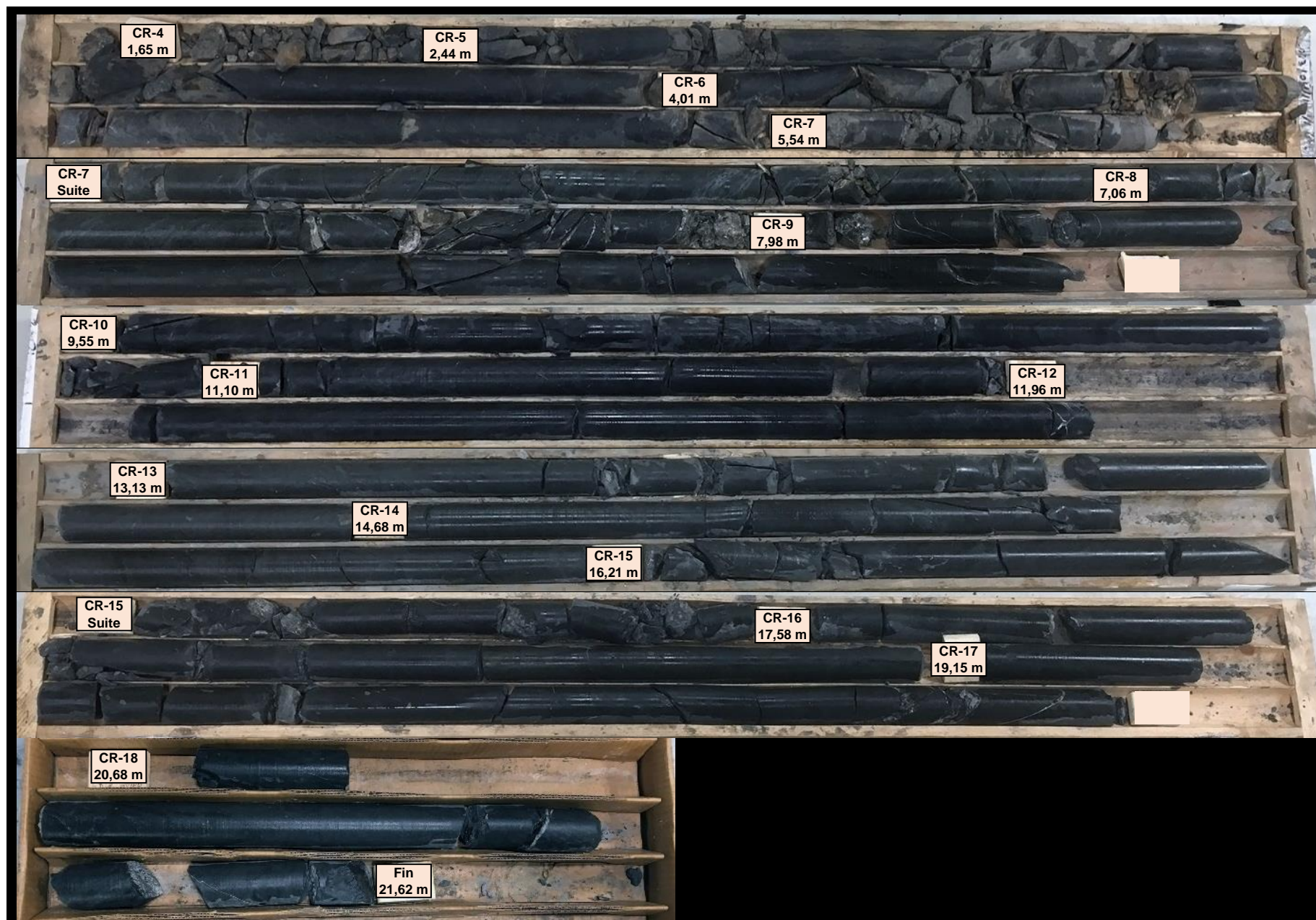
Photographie # 48 : Carottes de roc du forage TW10-F-25 état mouillé (CR-4 à CR-18).
