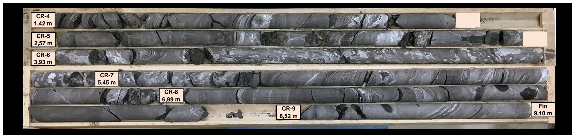
Photographie # 93 : Carottes de roc du forage TW10-F-50 état sec (CR-4 à CR-9).
