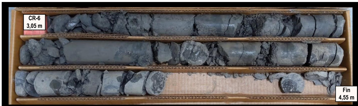
Photographie #3 : Carottes de roc du forage TW01-F-14 (CR-6).
