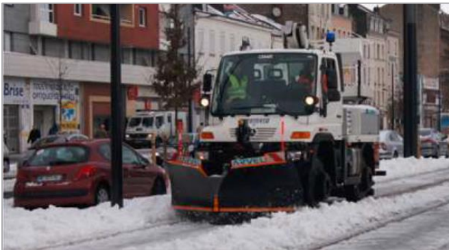
Photo 6.16 Véhicule de type rail route équipé d'une lame à neige
