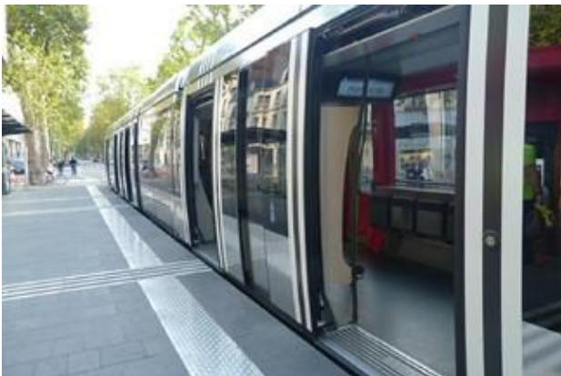
Photo 6.3 Accès plain-pied entre rames et quai, et plancher bas intégral permettant une accessibilité universelle
