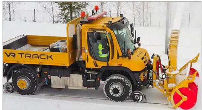
Photo 6.17 Véhicule de type rail route équipé d'une fraise à neige
