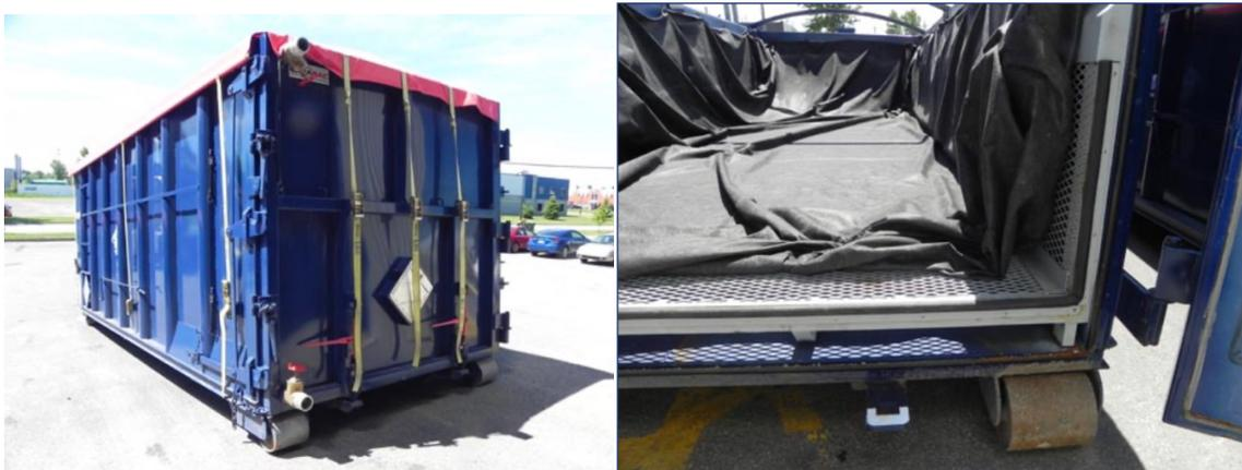
Figure 2. Conteneurs étanches et filtrants de 20 verges cubes et vue sur l'intérieur avec base filtrante.
