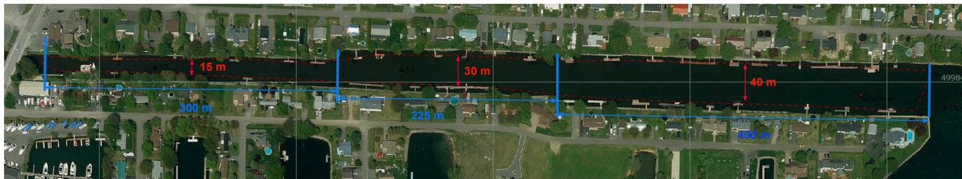
Figure 1. Largeur moyenne de la zone de dragage des différentes parties du canal 5.
