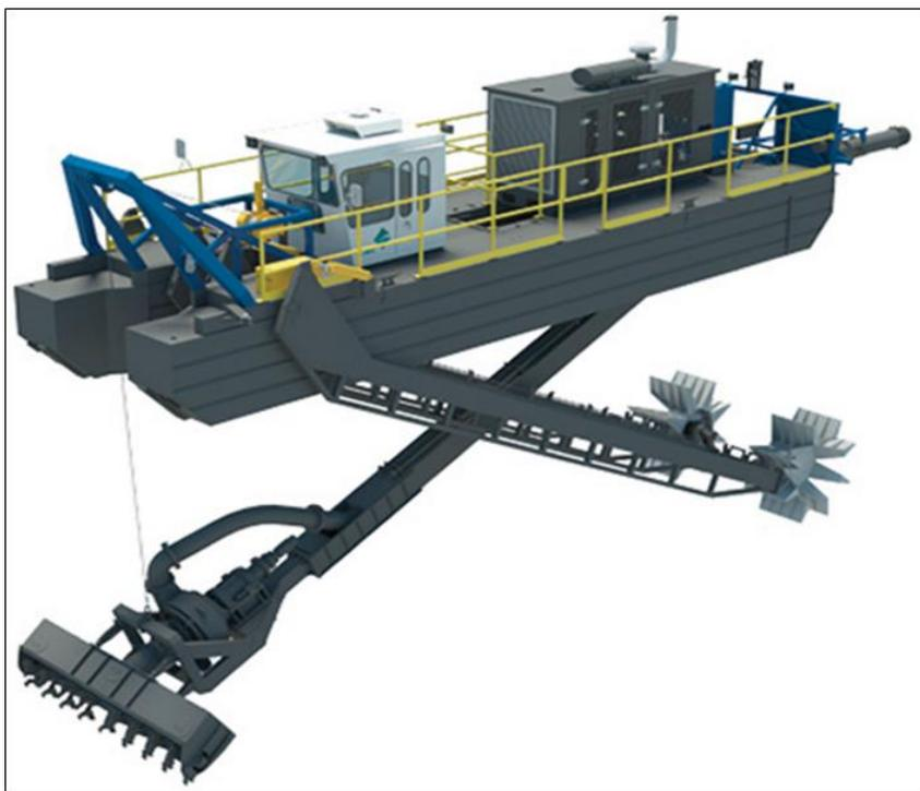
Comme la plupart des dragues, la drague suceuse à désagrégateur est généralement équipée de deux pieux descendus dans le fond marin ou encore de son propre système de locomotion (comme dans la figure 4.3).
