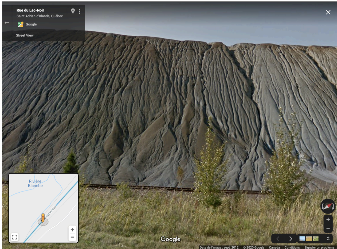
Figure 5 : Exemple d'érosion hydrique sur le versant d'une halde minière. Source : Google street view
