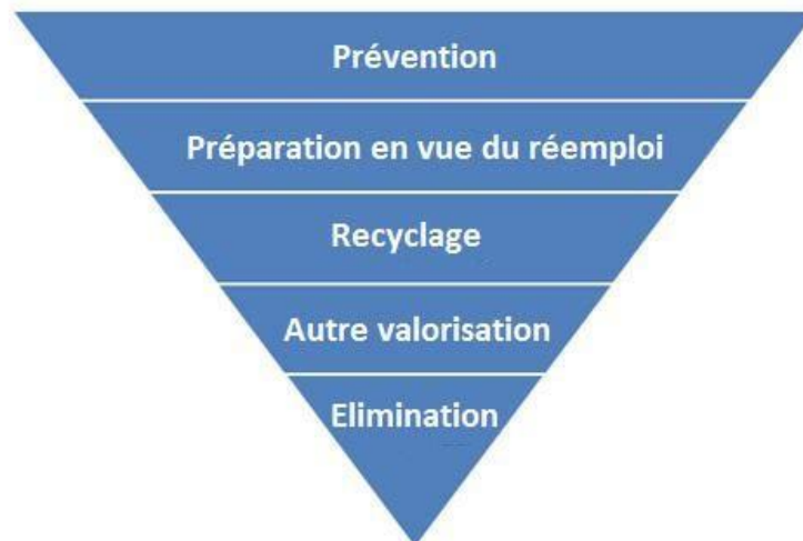
Illustration 8: Hiérarchie des modes de traitement des déchets (Source : inspiré de l'Agence Européenne pour l'Environnement)
