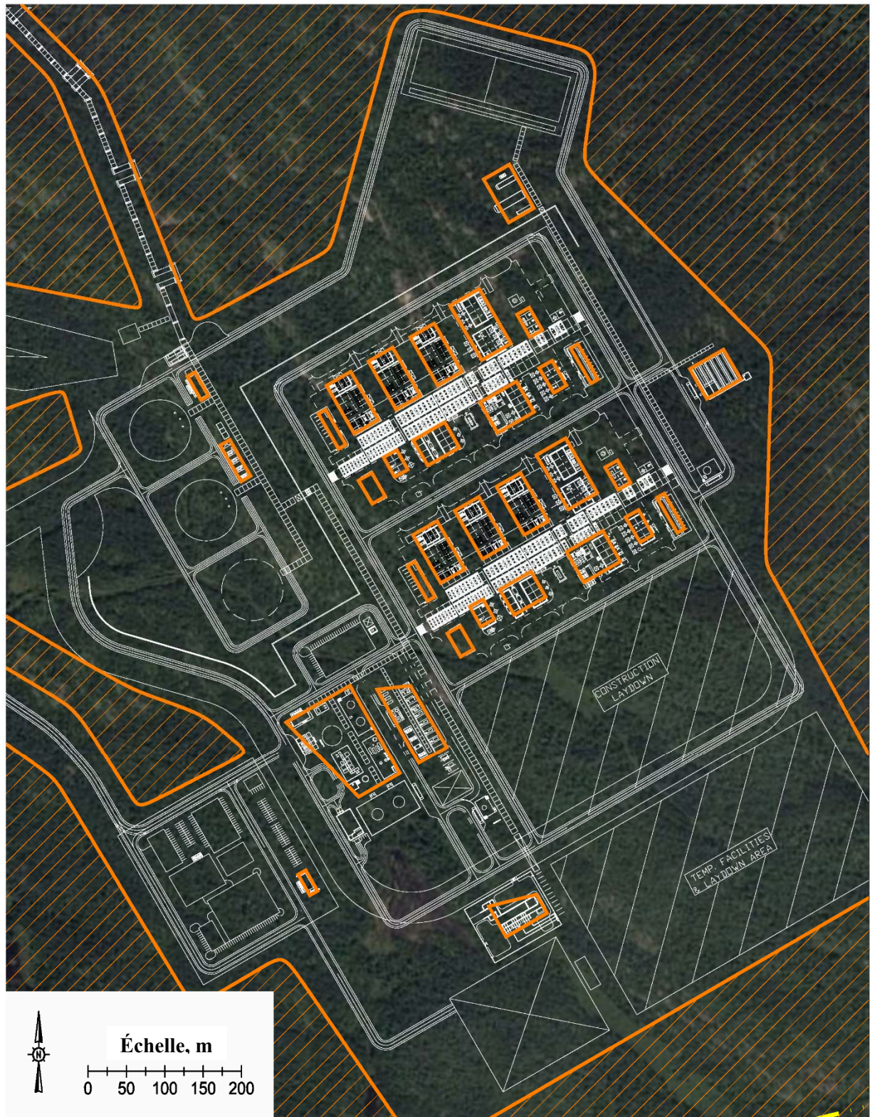
Figure A-2 Sites d'explosion potentiels à l'usine de GNL d'Énergie Saguenay
