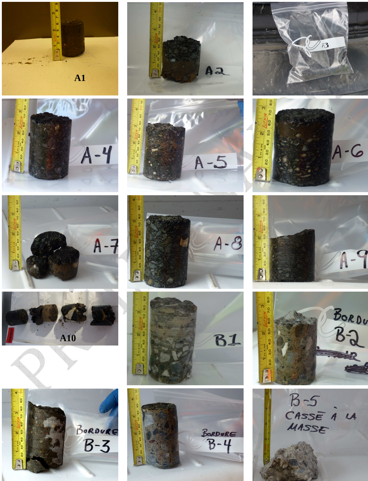
Figure 4 Carottes de béton et d'asphalte.
