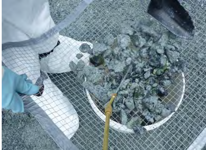
Figure 4.14 : Lavage et tamisage des échantillons NA-HA-06 et NA-HA-07
