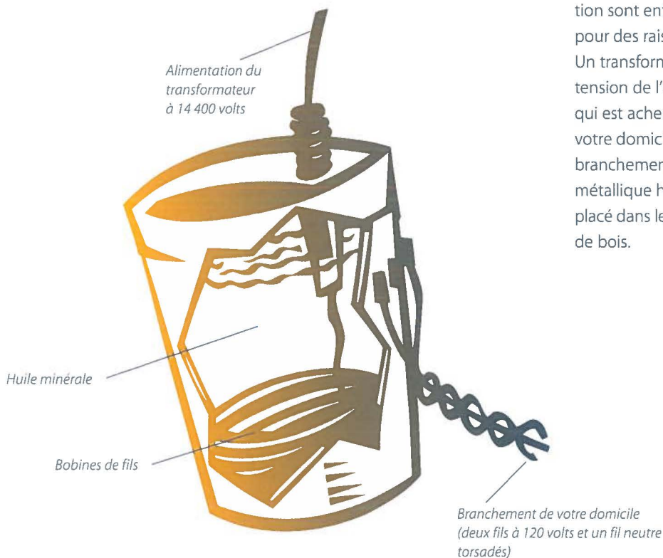
Transformateur de distribution
