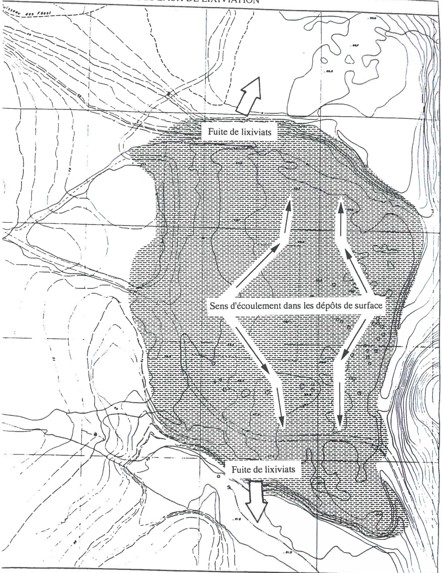
FIGURE 4: L'ÉCOULEMENT DES EAUX DE LIXIVIATION
