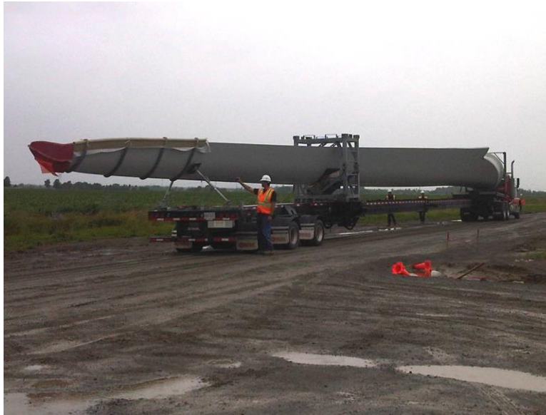
Figure 2.3 Transport des composantes (source : Kruger Énergie)
