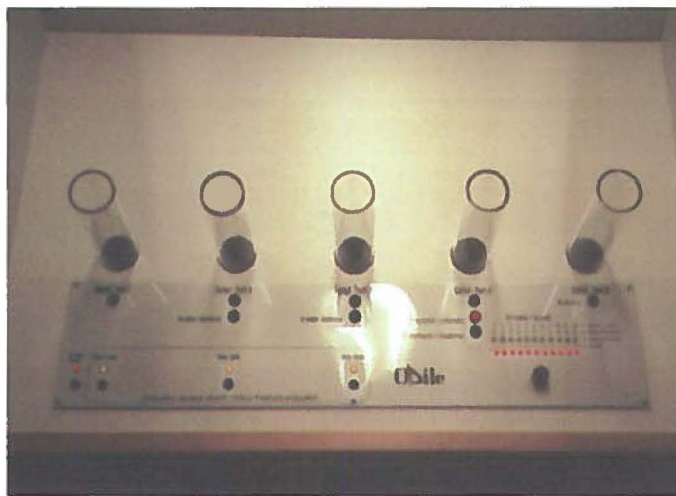
Figure 3 Poste de flairage des odeurs
