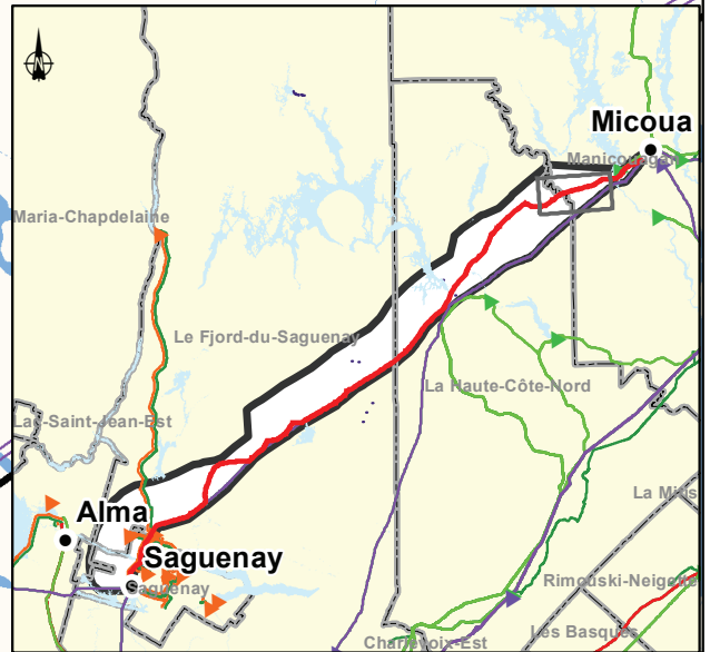
Ligne à 735 kV Micoua-Saguenay
