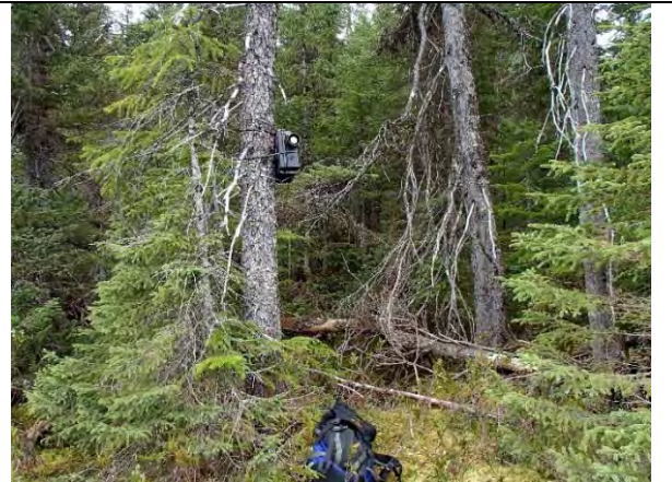
Photo 4 - Station d'inventaire acoustique fixe pour les chiroptères
