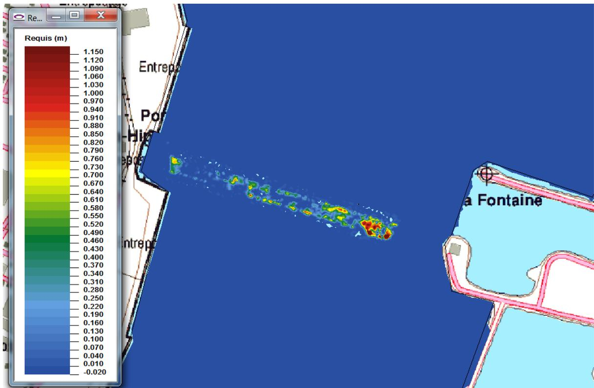
Figure 2-3 Recouvrement additionnel requis pour obtenir une couche d'au moins 2,16 m au-dessus du tunnel.
