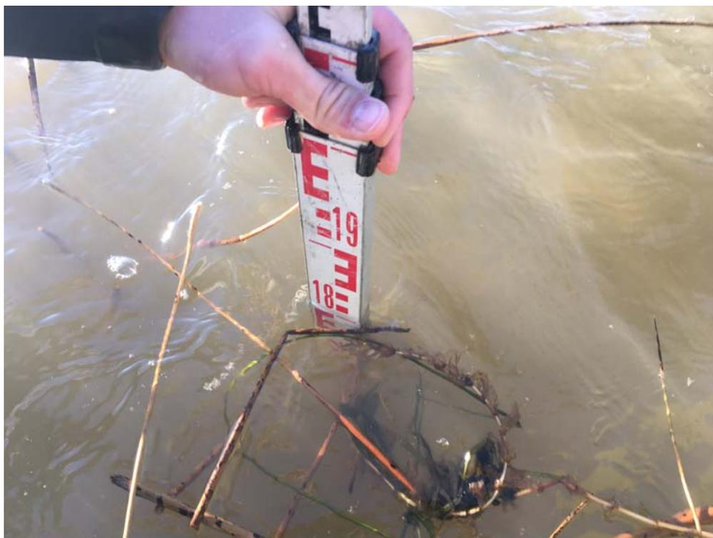
Photographie 17 Profondeur du cratère au projectile B2-0109 – 3po50 cal – 1,1 m profond + 0,7m eau = 1.8 m
