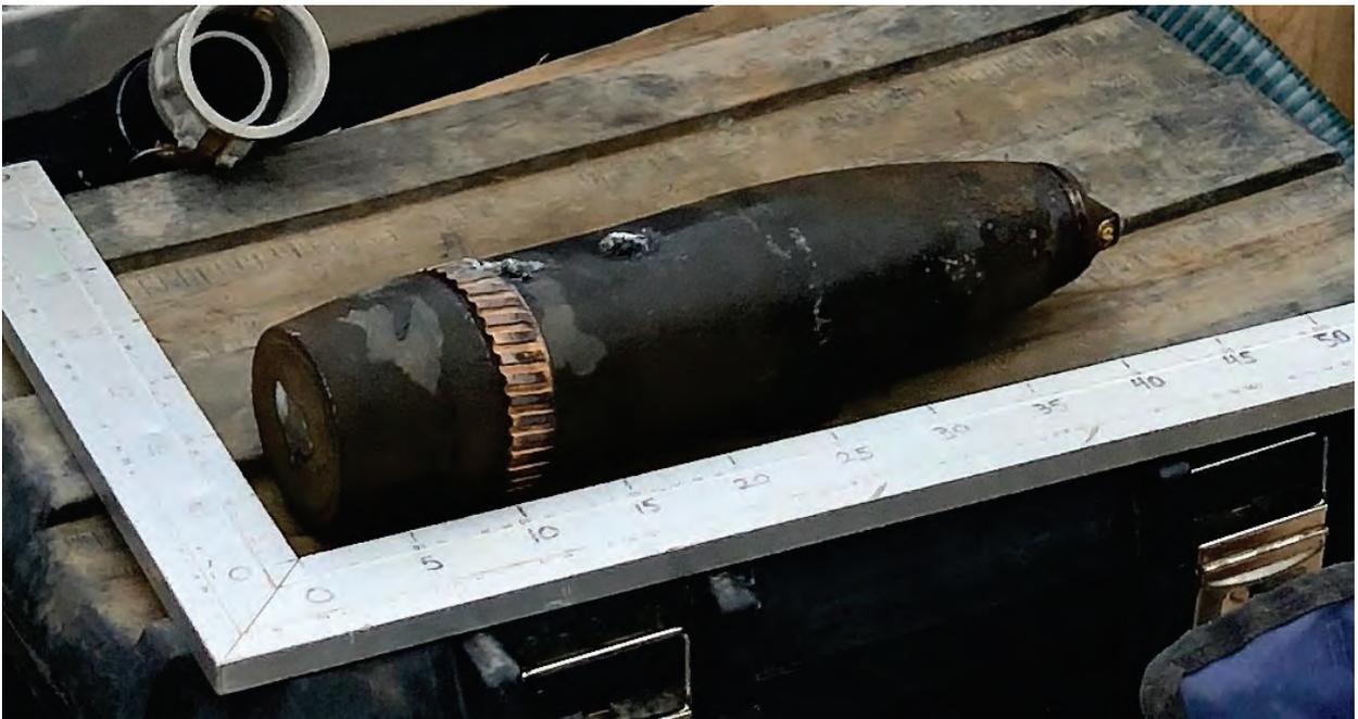
Photo 16 – Exemple d'un projectile inerte après tentative de détonation
