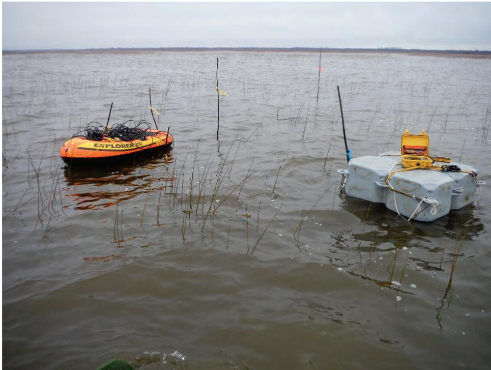
Photo 1 – Hydrophones installés au site de la munition 1236 avant détonation le 6 novembre 2018.
