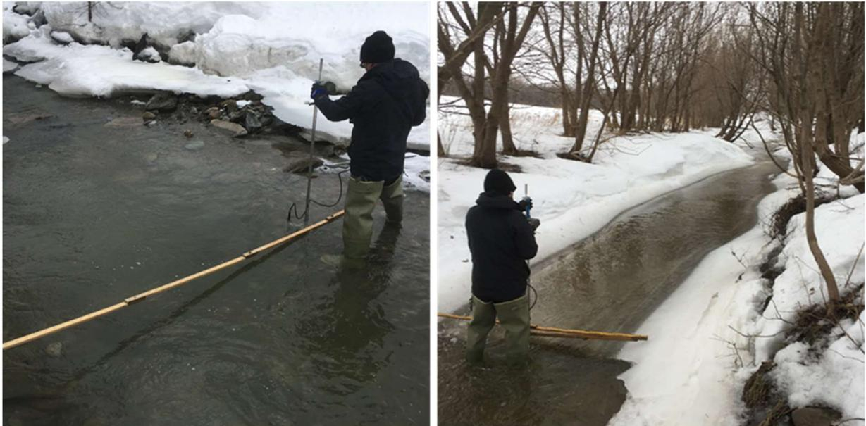
**Figure 4. Jaugeage de la station Michaud et Parent à l'Hiver 2018.**
