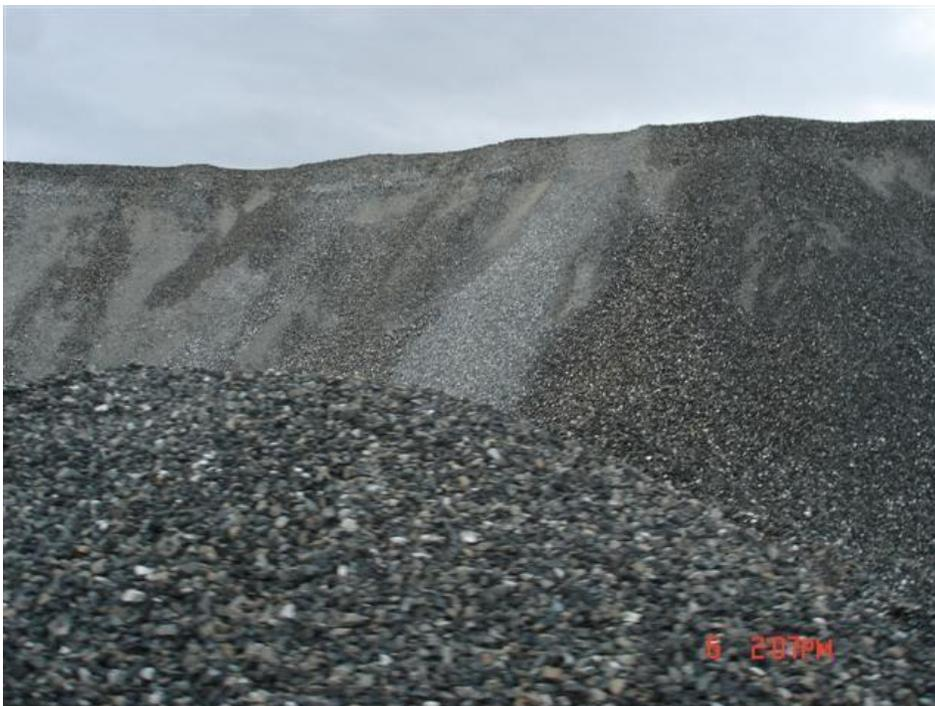
**12e) Érosion en rigoles et accumulation de fibres d'amiante au site de la mine King-Beaver.**
