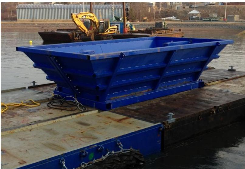
Figure 17 Barge de transport du matériel dragué
