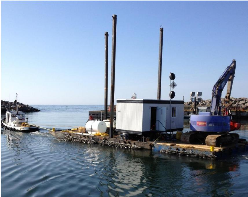
Figure 10 Petite drague à benne preneuse
