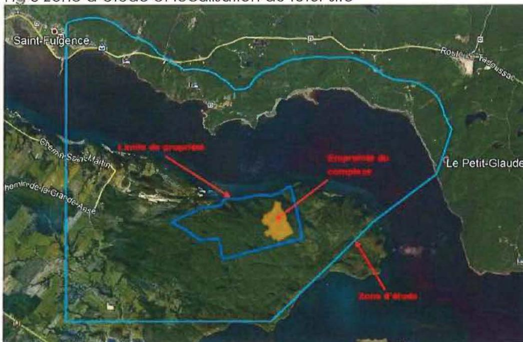
Le mandat de WSP a été la réalisation d'une étude prévisionnelle de la propagation sonore des activités de construction et d'opération du complexe, puis de vérifier sa conformité acoustique avec la réglementation, en appliquant un modèle informatique à l'aide de SoundPlan.
