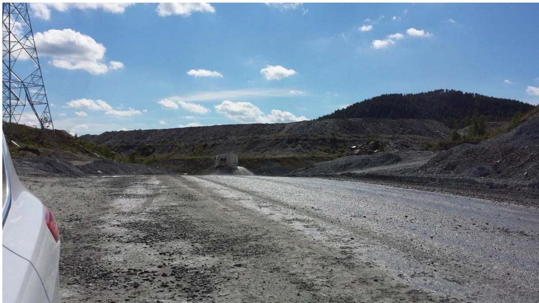
Photographie 2 : Exemple de rabattement des poussières sur les chemins miniers utilisé pour la circulation dans la zone des travaux.
