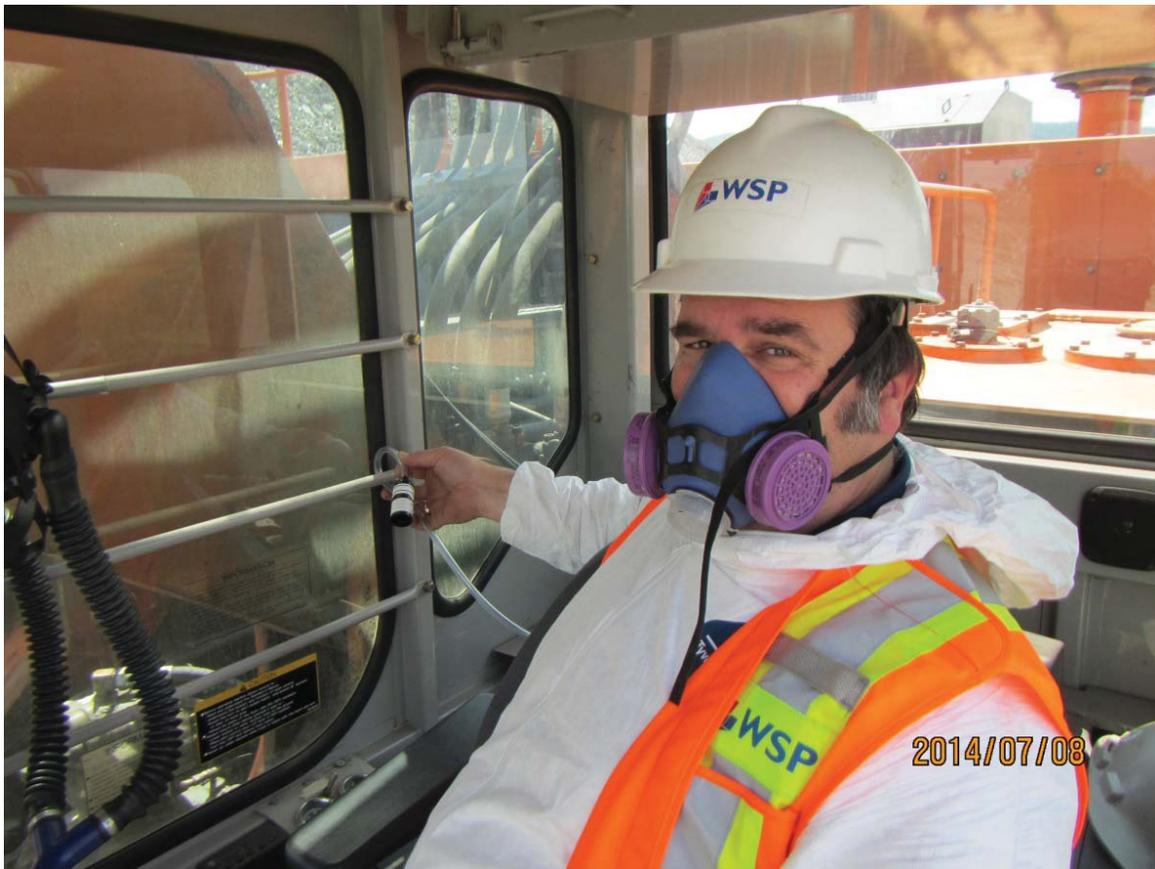
Photographie 7 : Exemple d'une installation de cassette pour le prélèvement d'amiante dans la cabine d'un véhicule lourd.
