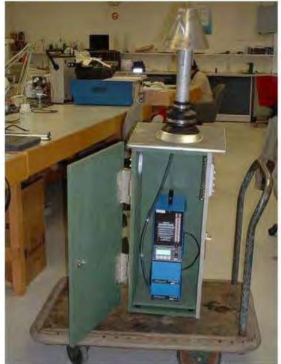
Figure 2 : Casette d'échantillonnage
