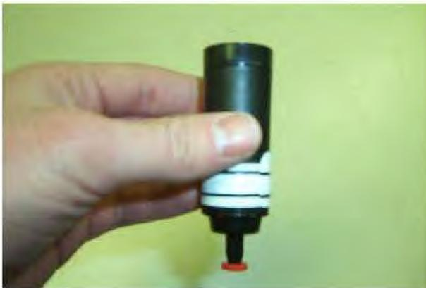
Figure 3 : Casette d'échantillonnage
