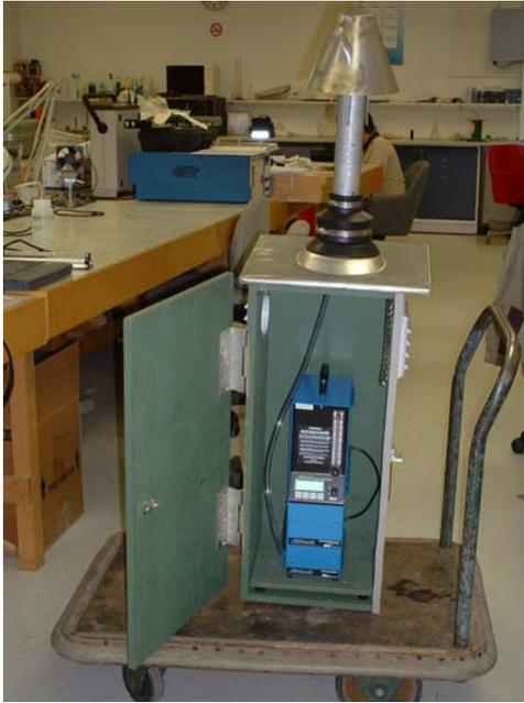
**Figure 5 : Photo de l'échantillonneur Sensidyne, modèle Gilian AirCon-2 et son abri**
