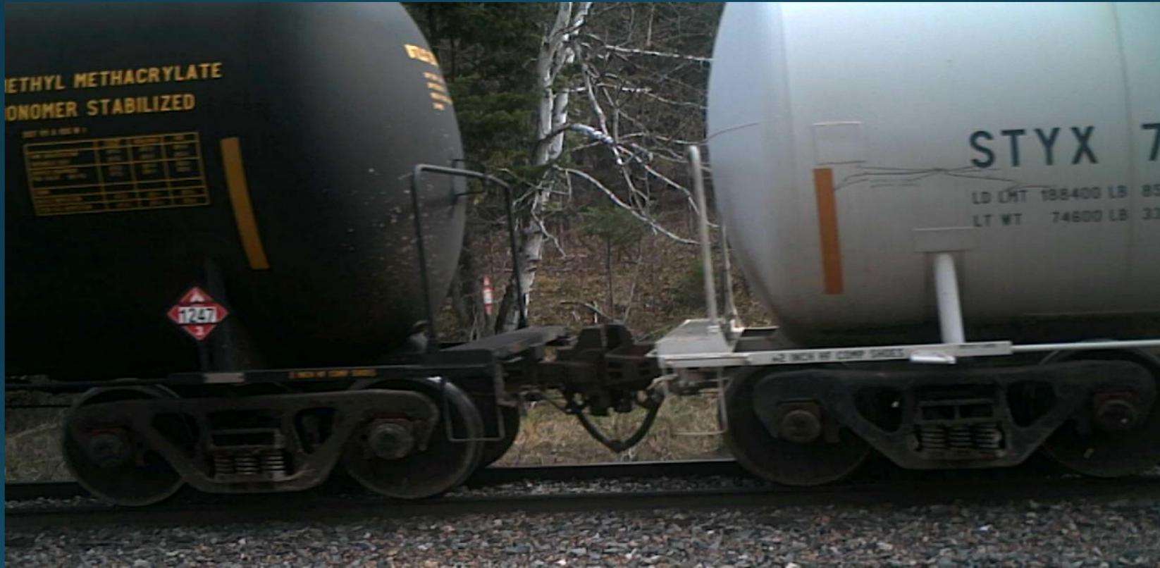
Photo-14 (Classe 1247, Methacrylate de Methyl, monomère stabilisé, fréquent, 2 citernes par convoi)
