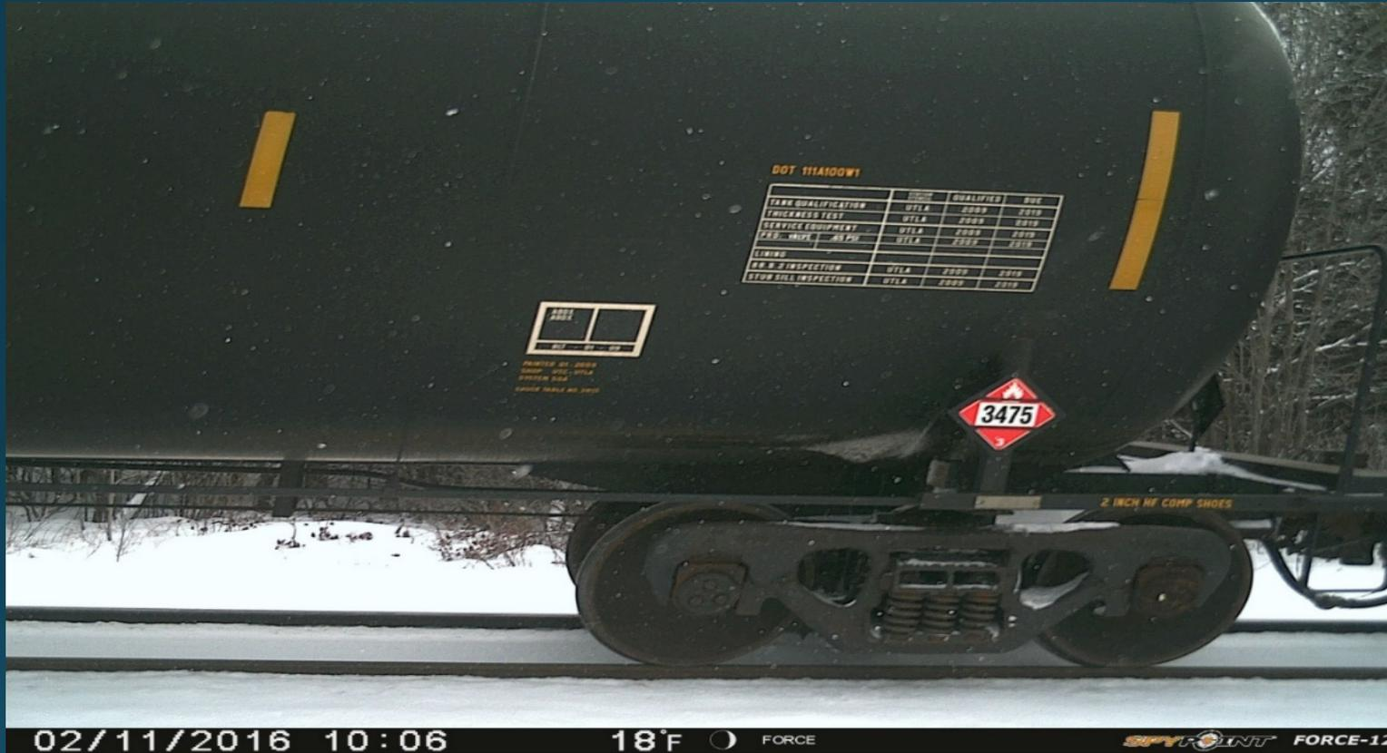
Photo-15 (Classe 3475, Essence automobile avec 10% d'éthanol, fréquent, moyenne 2 citernes par convoi)
