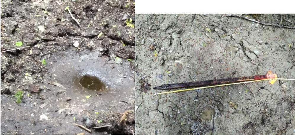
figures 6 et 7 : sol végétal humide avec base argileuse au sud de la route 161 devenu dangereux et qui a dû être sécurisé lors d'une tranchée exploratoire pour le projet
