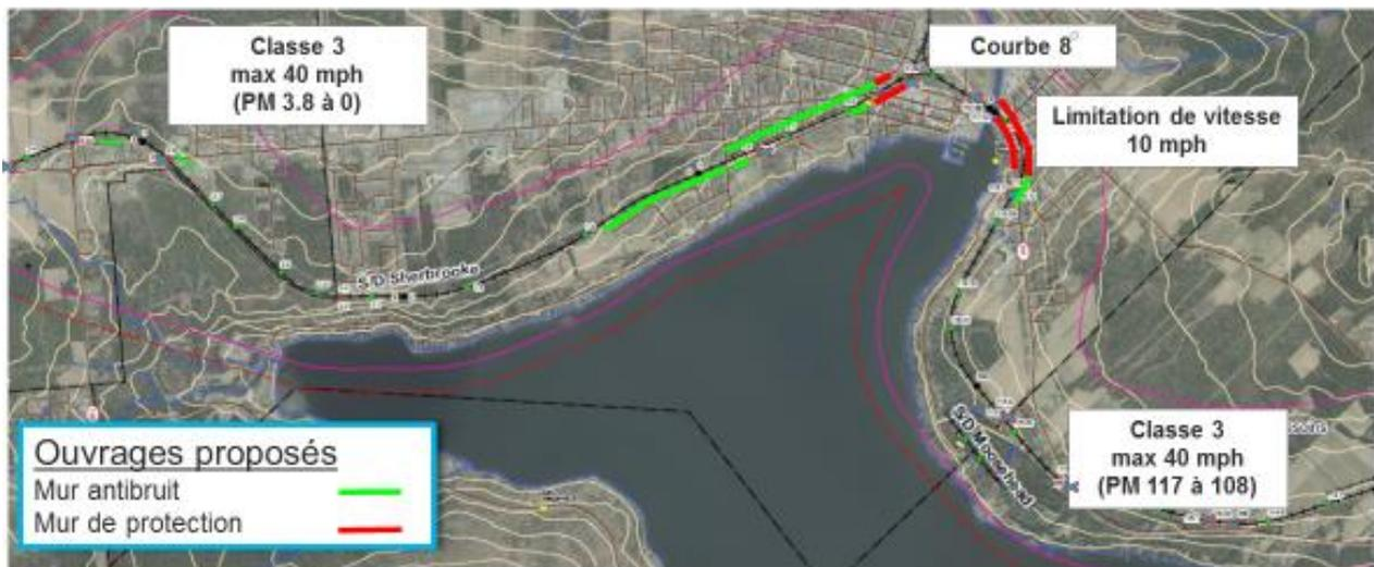
**Figure 4-C Localisation approximative des écrans antibruit et des murs de protection**
